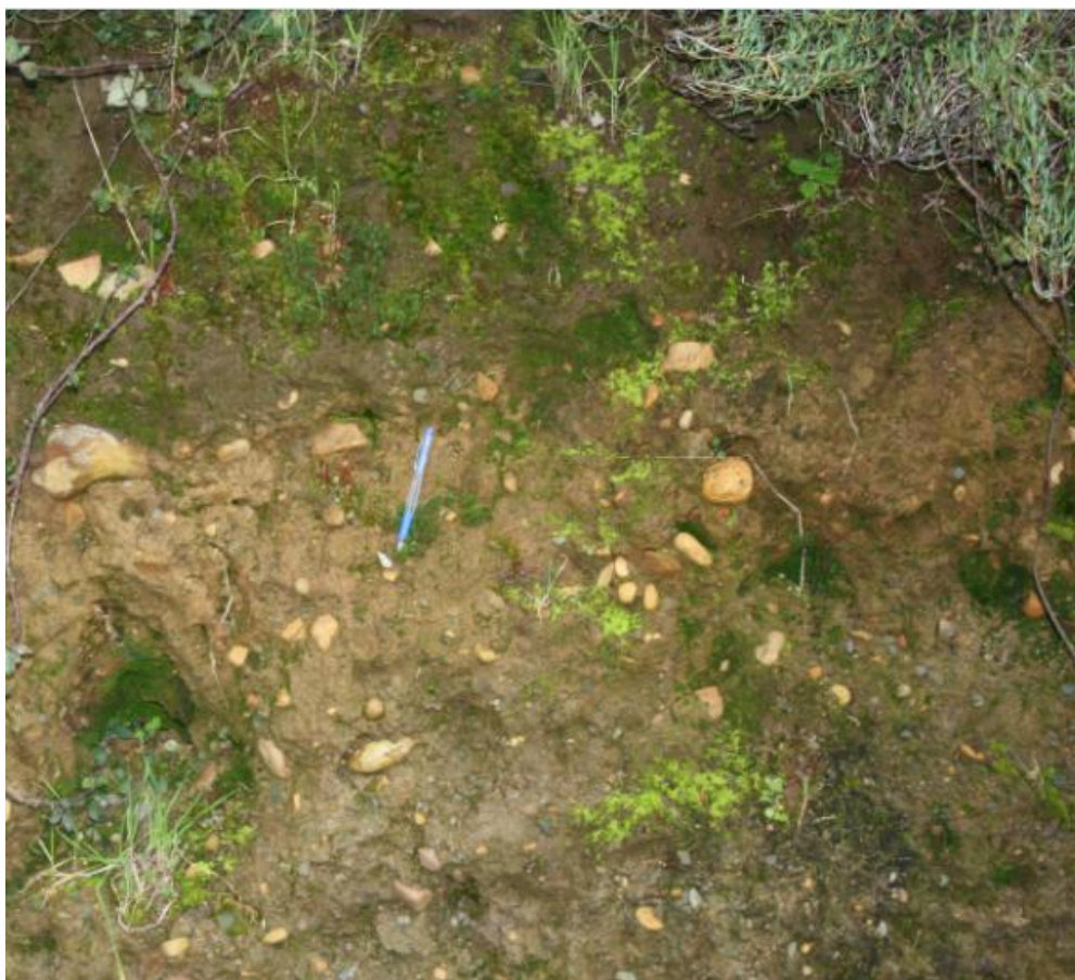
Figura 3.1.- Afloramiento en corte del coluvión arcilloso en una carretera local por detrás de la estación de tren, en el sector de “Las Cortes”.
