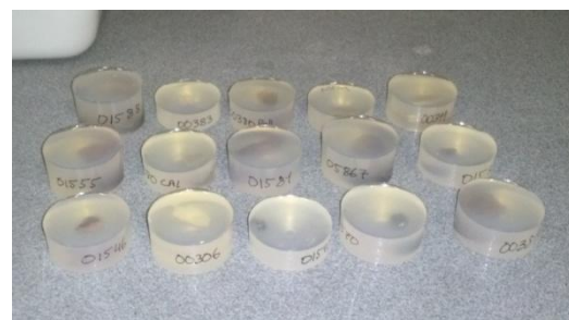
Figura 23. Izquierda: Muestras sumergidas en la resina epoxi en recipientes etiquetados. Derecha: Probetas de las muestras con la resina seca.
