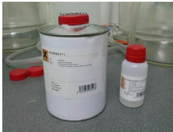
Figura 22. Estireno y catalizador que, junto a la resina crystic, da lugar a la resina epoxi.
