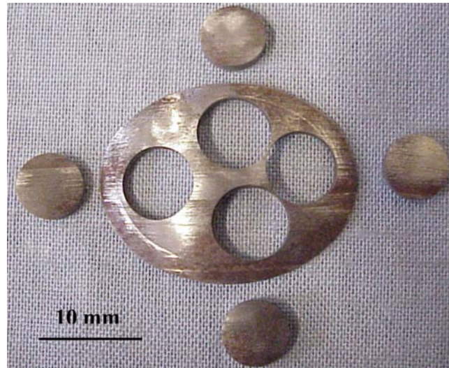
Figura 1.2: Ejemplo de preparación de probetas mediante corte por electroerosión a partir de un trozo de material [3]
