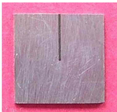
Figura 2.19: Probeta entallada utilizada por Lacalle et al. [86]
