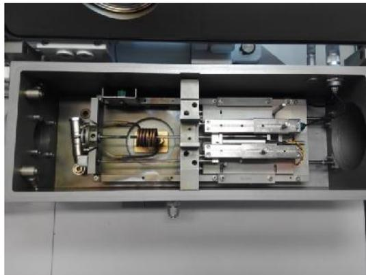
**Figura 3.3 Cámara del dilatómetro en la que se coloca la probeta durante el ensayo.**
