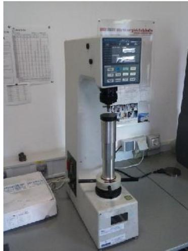
**Figura 3.5. Durómetro automático empleado para determinar la dureza de las muestras**
