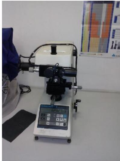
**Figura 3.6. Microdurómetro empleado para las mediciones de la microdureza en la matriz.**
