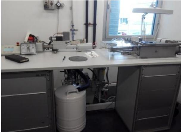
**Figura 3.1. Dilatómetro empleado en los tratamientos térmicos de las fundiciones**
