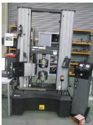
Figura 3.10. Máquina de tracción empleada en los ensayos de tracción.
