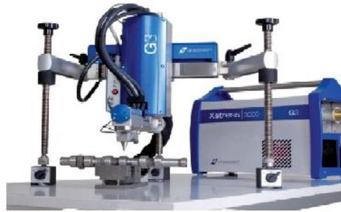
Imagen 3.4. Imagen del equipo de difracción empleado para el cálculo de la austenita retenida.
