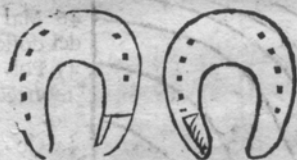
Ferri che sono più grossi, & più stretti nel quarto di dentro dello ordinario.
