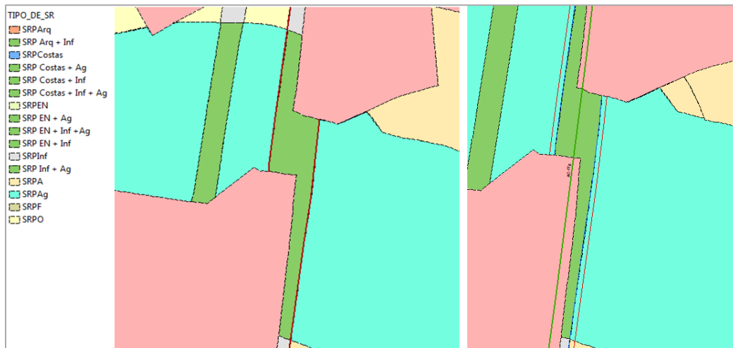
Figura 24. Actualización de la zona de protección de infraestructuras mediante la línea límite de edificación actualizada. En la figura se muestra a la derecha la protección antigua y a la izquierda la nueva protección. Se muestra la línea de límite de edificación actualizada en rojo, la línea de límite de edificación antigua en azul oscuro, la zona de protección de infraestructuras en gris, la zona de protección de aguas en azul y la zona de protección de infraestructuras más aguas en verde. En rosa se muestran los núcleos urbanos.
