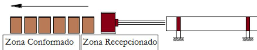
Ilustración 12: Sistema de desplazamiento por actuador lineal
