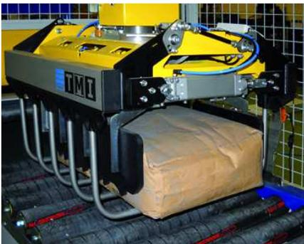
Ilustración 10: Pinza Robótica
