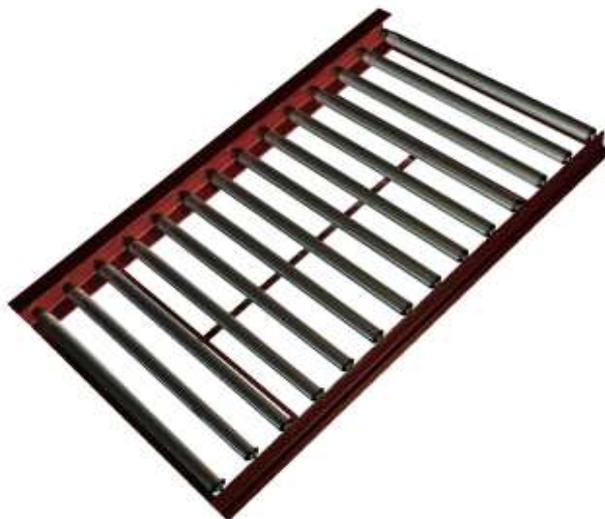
Ilustración 20: Apariencia del transportador de rodillos para la zona de recepción
