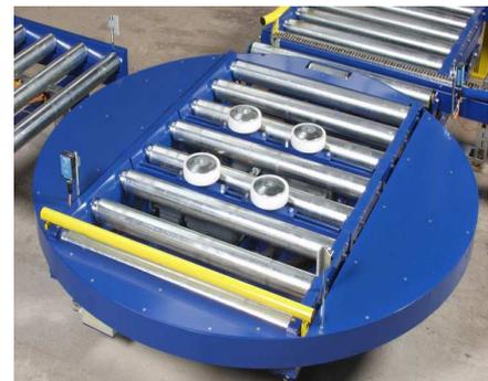
Ilustración 9: Rodador del Transportador
