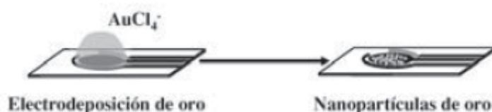
Figura 1.4. Modificación de los electrodos serigrafiados con AuNPs.
