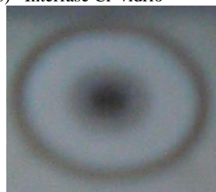
Figura 25. Forma de los cráteres en la medida hecha con la cámara de descarga de 4 mm, a 70 W y 110 Pa.
