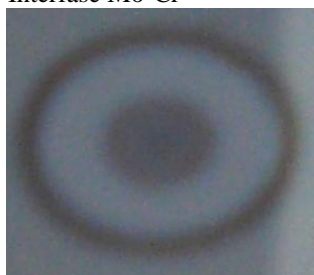
Figura 25. Forma de los cráteres en la medida hecha con la cámara de descarga de 4 mm, a 70 W y 110 Pa.
