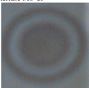
Figura 27. Forma de los cráteres en la medida a 70 W y 180 Pa con la cámara de descarga de 4 mm.
