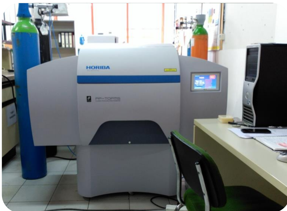
Figura 5. Equipo PP-TOFMS empleado en este TFM situado en el laboratorio de Glow Discharge del Departamento de Química Física y Analítica de la Universidad de Oviedo.
