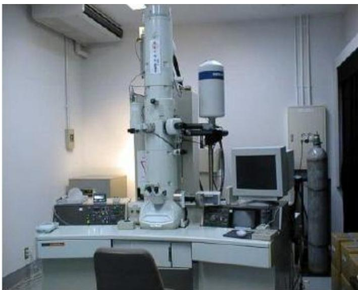
***Figura 19. Microscopio Electrónico de Transmisión. Jeol 2000 EX – II.***
