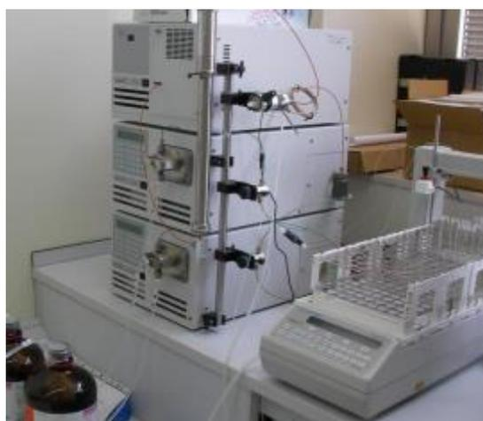
**Figura 13.**Cromatógrafo HPLC semipreparativo modelo ProStar Variant.
