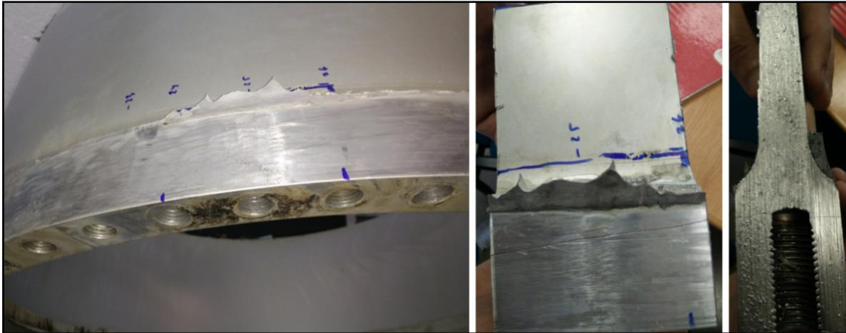
Figura 5.3 Detalle dirección crecimiento de grieta en el *aluring* 2.
