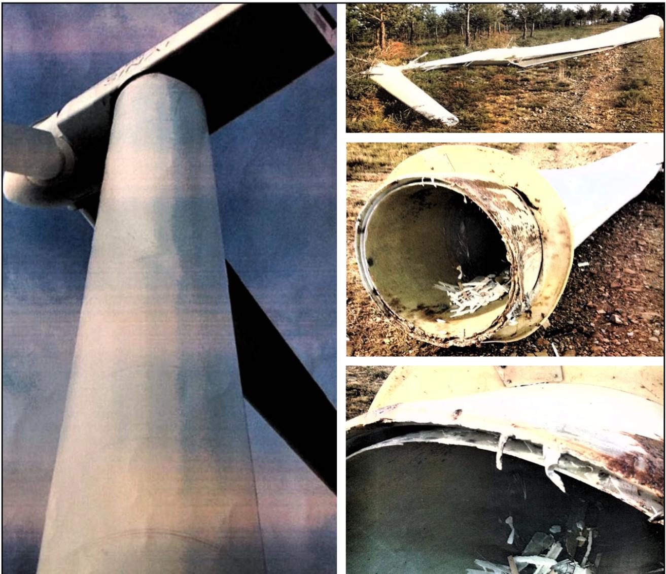
Figura 2.1 Aspecto del aerogenerador después del fallo del *aluring*.
