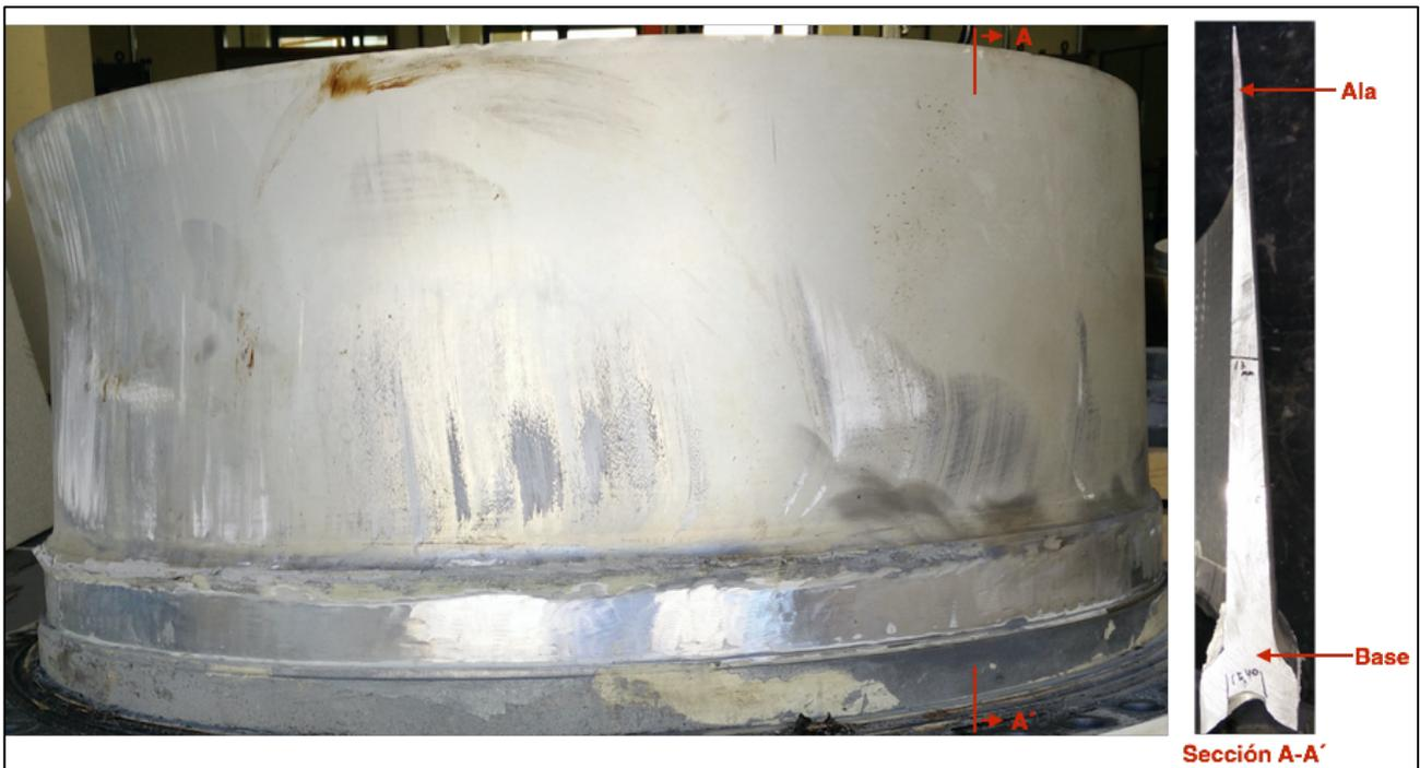
Figura 3.6 Partes del *aluring*.
