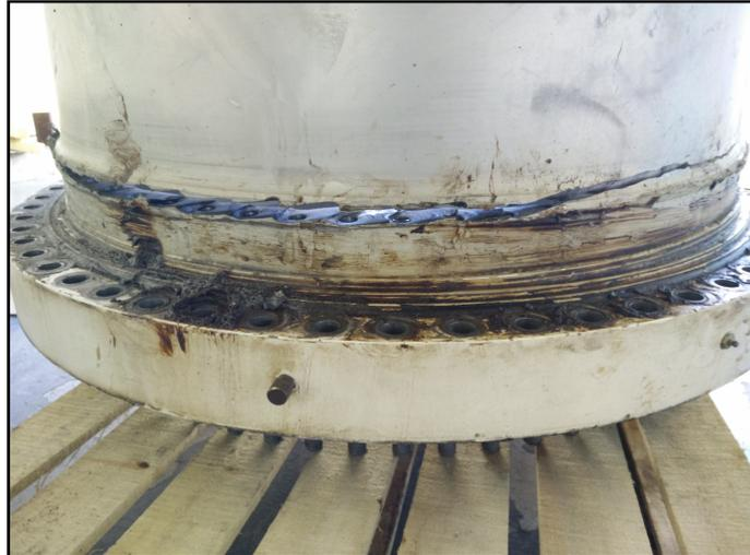
Figura 3.1 Detalle de la grieta macroscópica.
