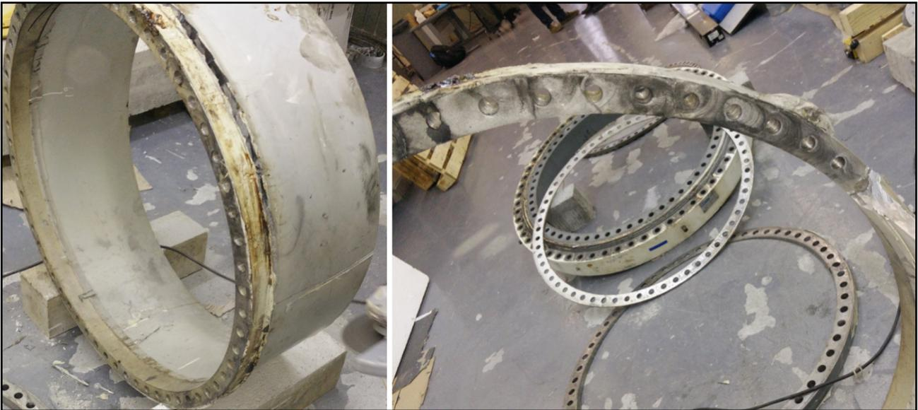
Figura 5.1 Detalle avance de la grieta en zona de mayor tensión.
