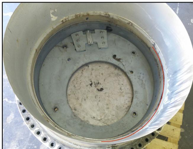
Figura 5.2 Detalle restos de adhesivo en la zona donde se encontraba la grieta.
