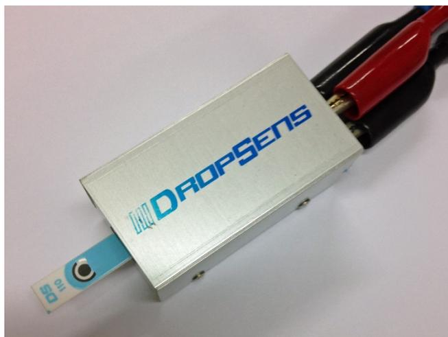
**Figura 3.2.** Conector con el electrodo serigrafiado
