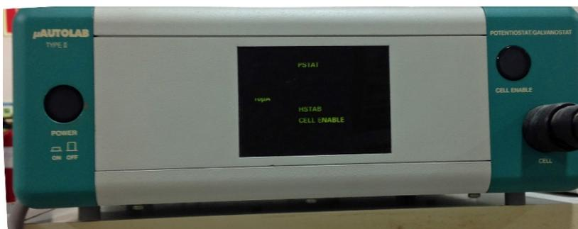
**Figura 3.1.** Potenciostato  $\mu$ AUTOLAB Type II
