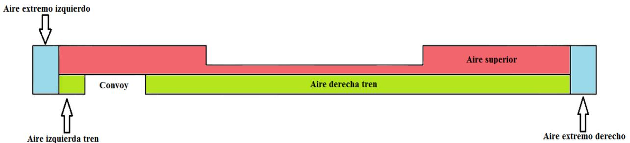
**Figura 5.- Zonas de fluido definidas en el modelo numérico.**
