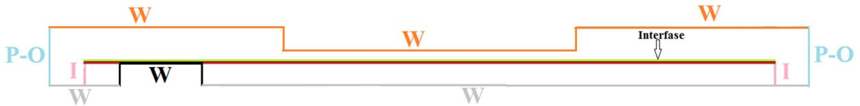
**Figura 4.- Condiciones de contorno en los bordes y en las líneas interiores.**
