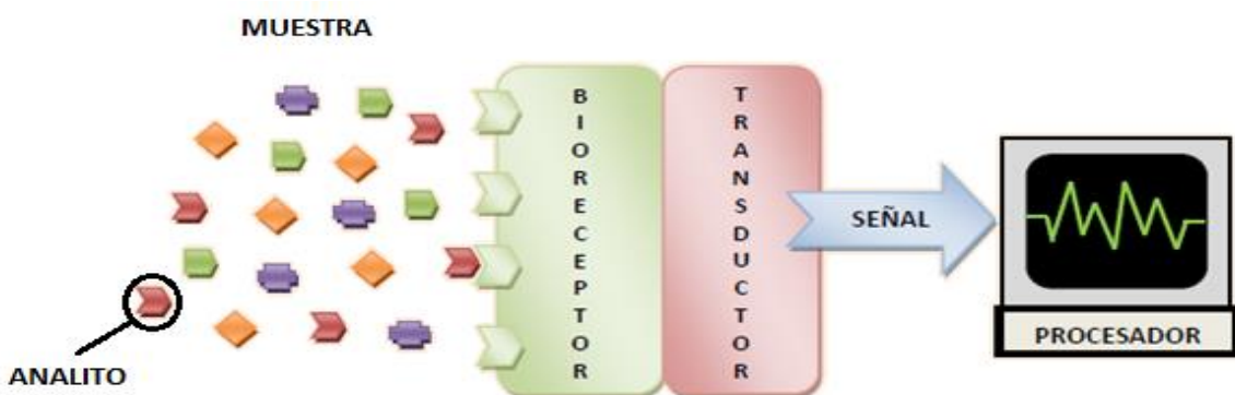
Figura 1.2.1. Representación esquemática de un biosensor.
