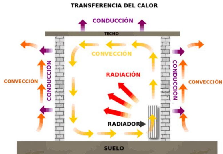
Fig. 2.5 Esquema general de la transferencia de calor por conducción, convección y radiación.
