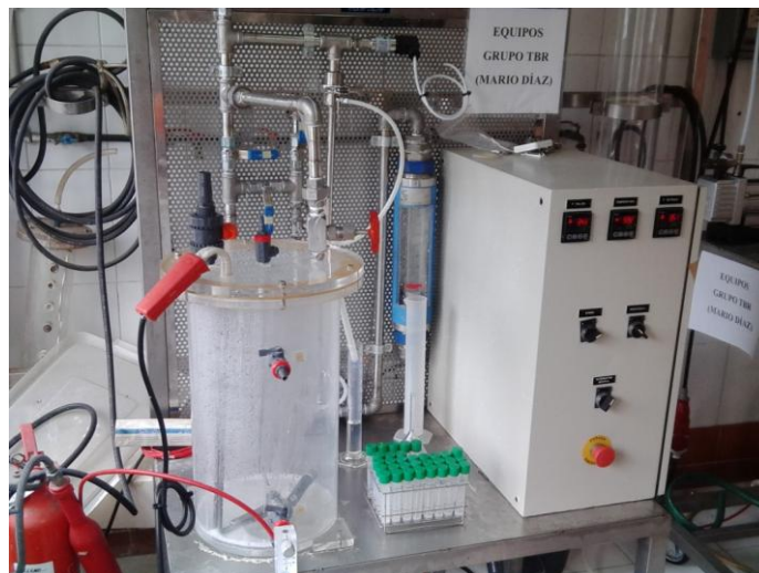
Figura 20: Equipo de membranas. A la izquierda, el tanque de alimentación; a la derecha, el armario eléctrico con los controladores.
