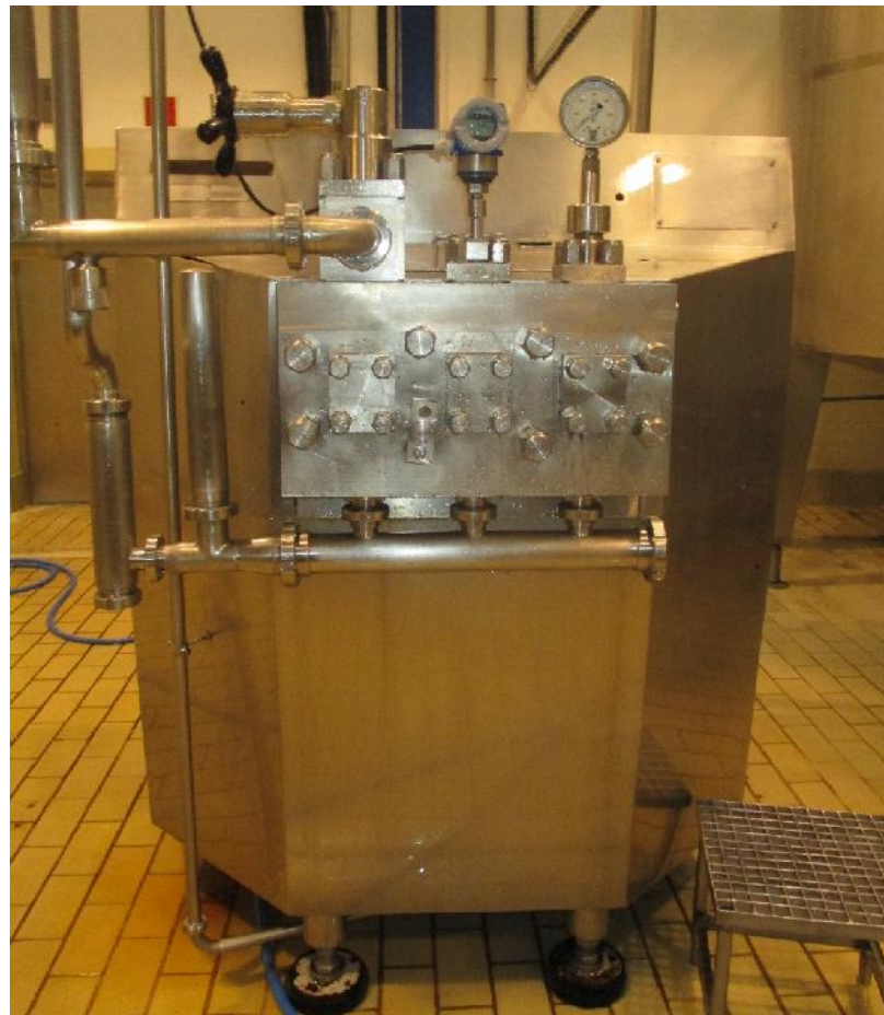
Ilustración 3: Homogenizador de Línea de Pasteurizado N°1
