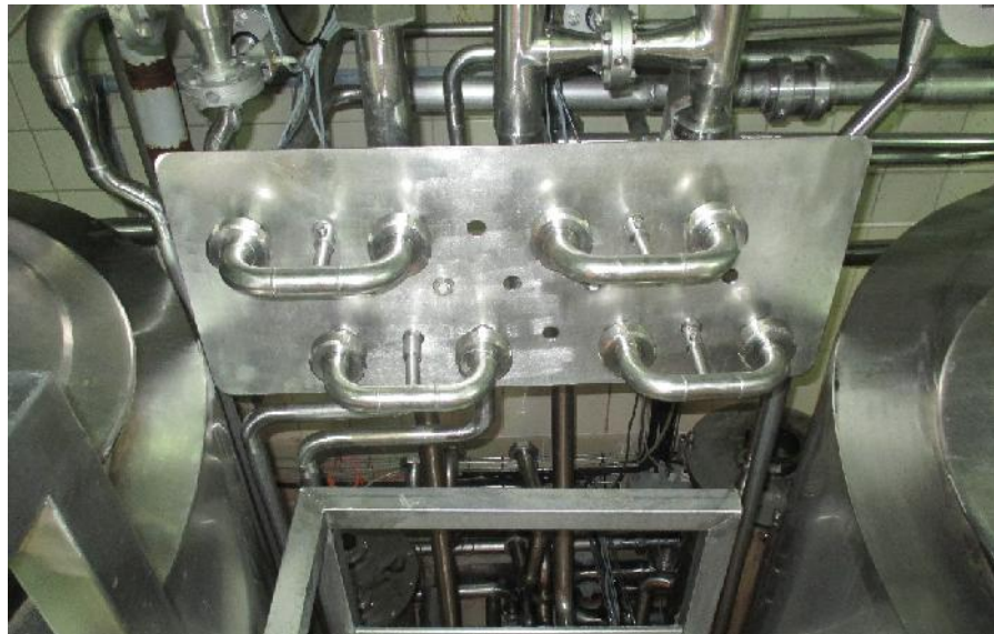
Ilustración 17: Bloque Multivías para Distribución de Limpieza y Circuito de Inyección de Fermentos en las Líneas de Siembra
