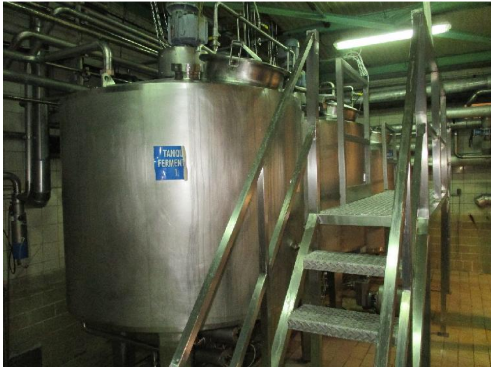
Ilustración 9: Tanques para la Preparación de Cultivo de Fermentos
