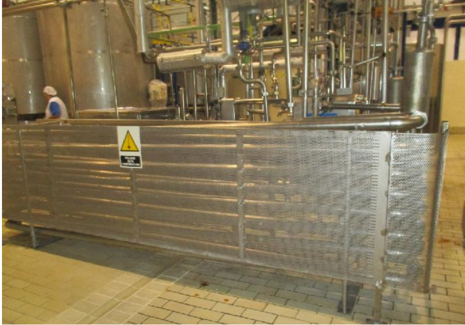
Ilustración 5: Tubos de Mantenimiento de Temperatura para Pasteurizado
