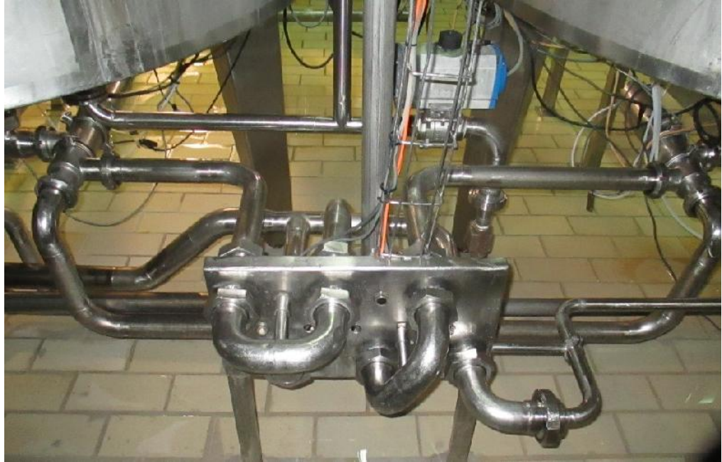
Ilustración 11: Bloque Multivias de las Líneas de Cultivo de Fermento N°1 y N°2
