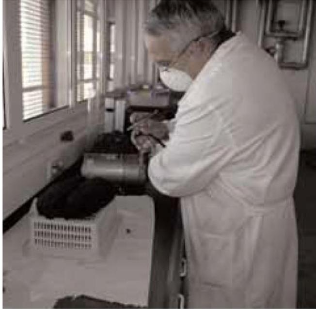
Fig. 4. Tratamiento de catalización por pulverización con aerógrafo (BOUZAS *et al.*, 2008, página 114)
