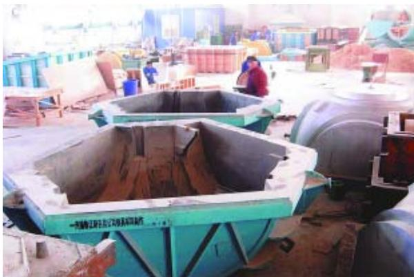
ra sobre el modelo maestro de madera. Una vez terminado, se vierte una capa de 10mm-20mm del sistema de colada RenCast® CW 2418 / HY 5162 para hacer un molde de la superficie de la estructura.
