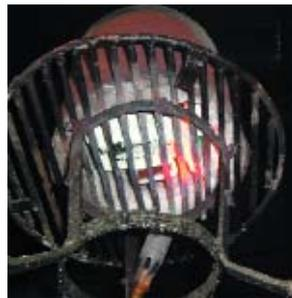
Figura 9. Cocción del molde. Alcance del estado cerámico.
