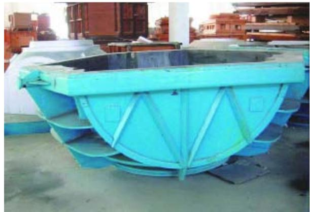
Utilizando un diagrama 2D proporcionado por sus clientes, se hace primero un modelo maestro del núcleo de arena en madera. Una vez más basados en el mismo diagrama, se diseña y prepara además la estructura de soporte de metal del modelo maestro.
