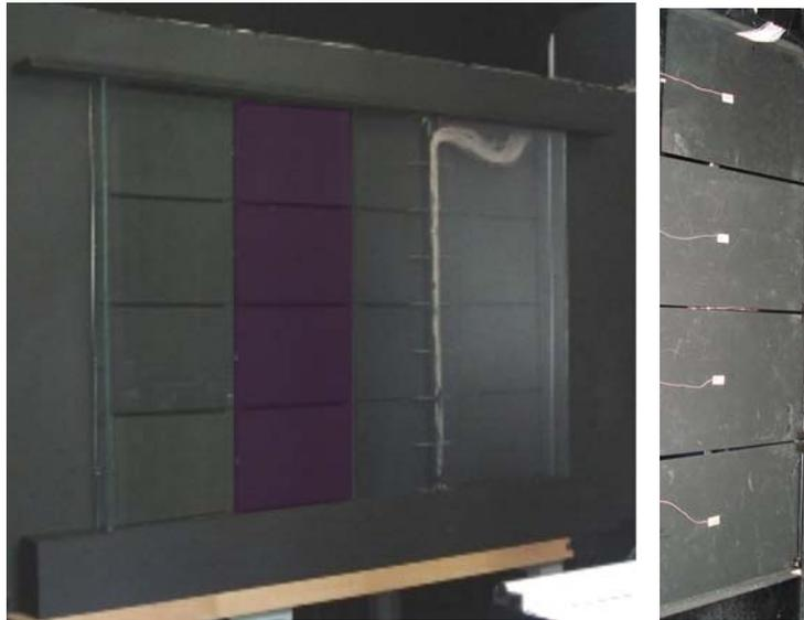
*Figura 3.22 Localización de los termopares de medida de la temperatura de superficie en las plaquetas.*
