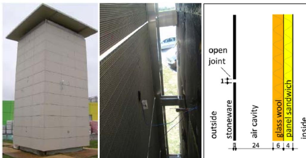
Figura 2.2 Imágenes de la experimentación: vista general de la torre (izqda.), imagen de la cámara de aire ventilada (centro) y esquema de composición de la fachada ventilada con las dimensiones en cm (derecha). Fuente: Marinosci et al. (2011).
