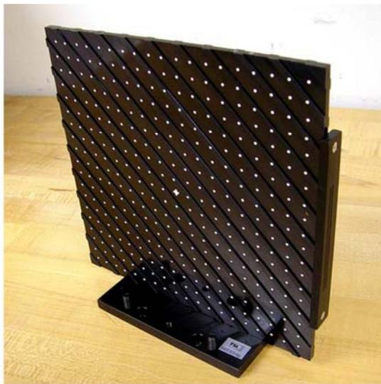
*Figura 3.32 Blanco de calibración tridimensional*
