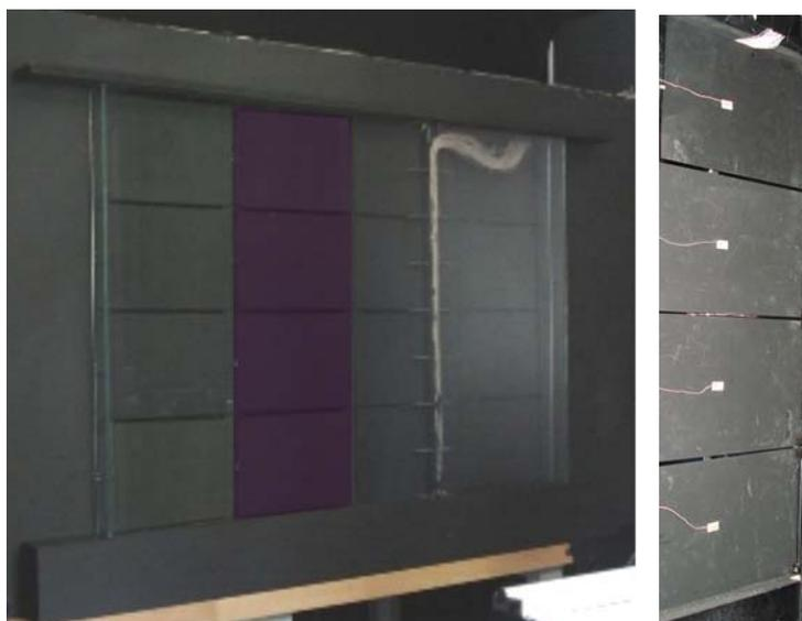
*Figura 4.8 Localización en la fachada ventilada de las plaquetas monitorizadas (izqda.), e imagen de los sensores instalados (dcha.).*
