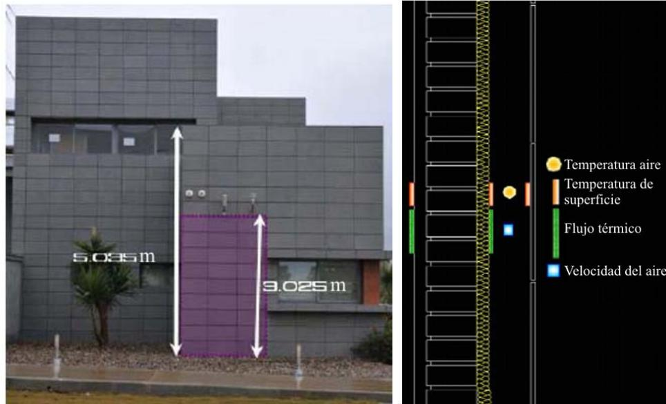
Figura 2.4 Imágenes de la experimentación: imagen de la fachada con la zona de estudio marcada en morado (izqda) y esquema de localización de los sensores en la cámara de aire ventilada y en el muro interior (derecha). Fuente: Giancola et al. (2012).
