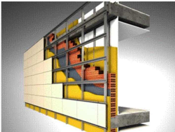
*Figura 3.16 Esquema de un cerramiento de una fachada ventilada.*
