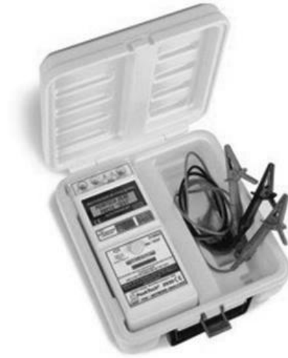
Figura 10: Comprobador de secuencia de fases. (Fuente: Medios Técnicos para los Instaladores Autorizados [Ediciones Experiencia, 2005] )
