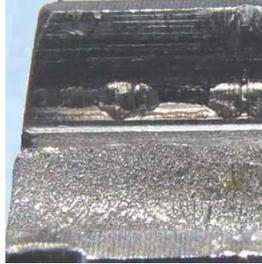
**FATIGA:** Fractura progresiva que se propaga durante el trabajo del engranaje. Su superficie es tersa y normalmente presenta marcas elípticas concéntricas al origen.
