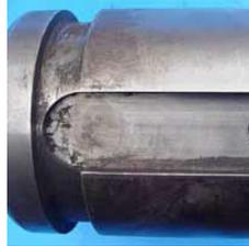
FATIGA SUPERFICIAL O PICADO: Agrietamiento superficial y posterior pérdida de material, formando pequeñas cavidades en la zona de contacto con el cojinete o seguidor.
