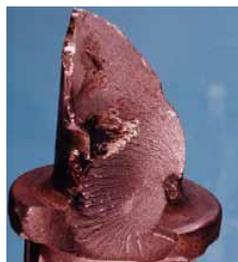
DÚCTIL POR TORSIÓN: Fractura transversal al eje con apariencia fibrosa y con deformación de la pieza siguiendo el sentido de rotación.
