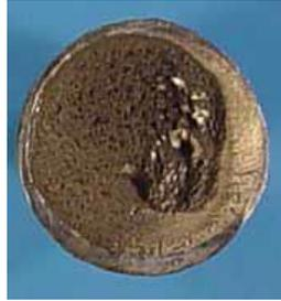
**FATIGA POR TORSIÓN:** Agrietamiento en servicio a 45° alrededor del eje. Superficie de fractura tersa sin deformación del eje, normalmente con marcas elípticas concéntricas al origen.
