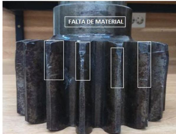
Este fallo en el engranaje es producido por el **desgaste** de los diferentes dientes del engranaje, se observa claramente que dicho desgastes es común en la misma zona de todos los diente, debido a estas características podemos decir que dicho fallo es producido por una mal montaje del engranaje, lo que produce roces o choques entre el engranaje con otros elementos produciendo el desgaste y la pérdida de material.
