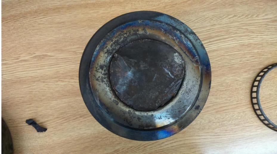
Debido a las claras marcas que podemos observar, tenemos claro que el fallo ha sido debido por un fallo térmico, este tipo de fallos se producen cuando los elementos están sometidos a altas temperaturas superiores para las que han sido diseñados.
