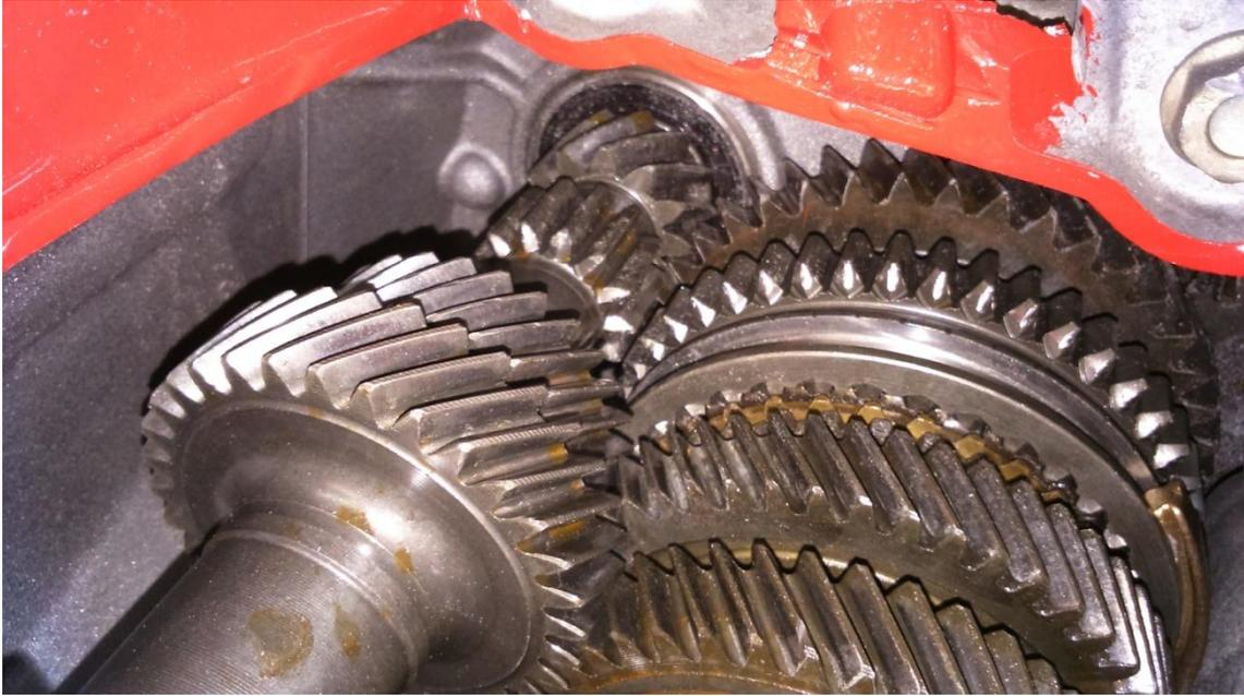
Podemos observar en uno de los engranajes en particular una forma de picadura en gran parte de los dientes del engranaje.
