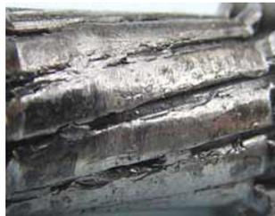
FRACTURA FRÁGIL: Fractura con apariencia granular brillante y sin deformación plástica aparente.
