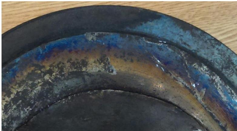
La rotura del eje es una combinación de un fallo térmico junto a un fallo por fatiga. Los esfuerzos de fatiga causados por variaciones rápidas de temperatura se deben a expansiones térmicas no uniformes causadas por gradientes de temperatura. La fatiga térmica solo se puede prevenir eliminando las deformaciones excesivas causadas por los ciclos térmicos.
