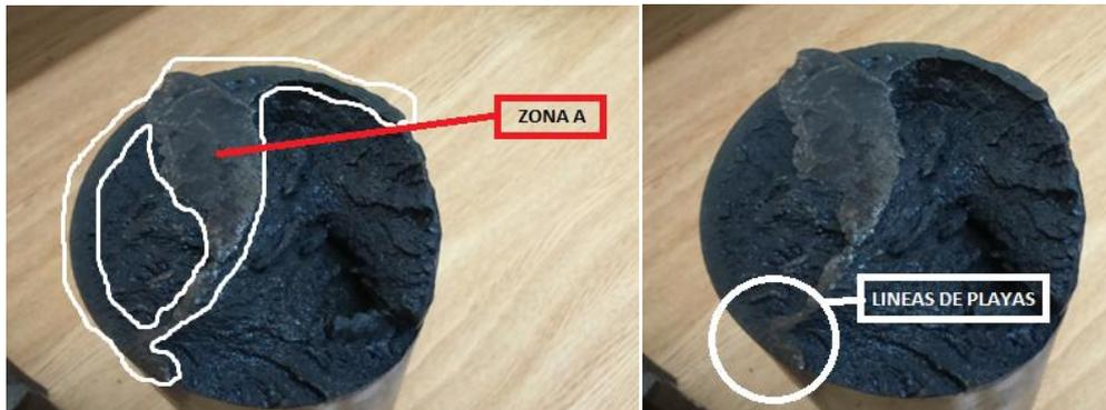
En la **zona "B"** es la sección final de rotura en la que desaparecen las líneas de crecimiento de las fisuras, desarrollándose micromecanismos de desgarro dúctil, observándose claramente una superficie rugosa con valles y montañas.
