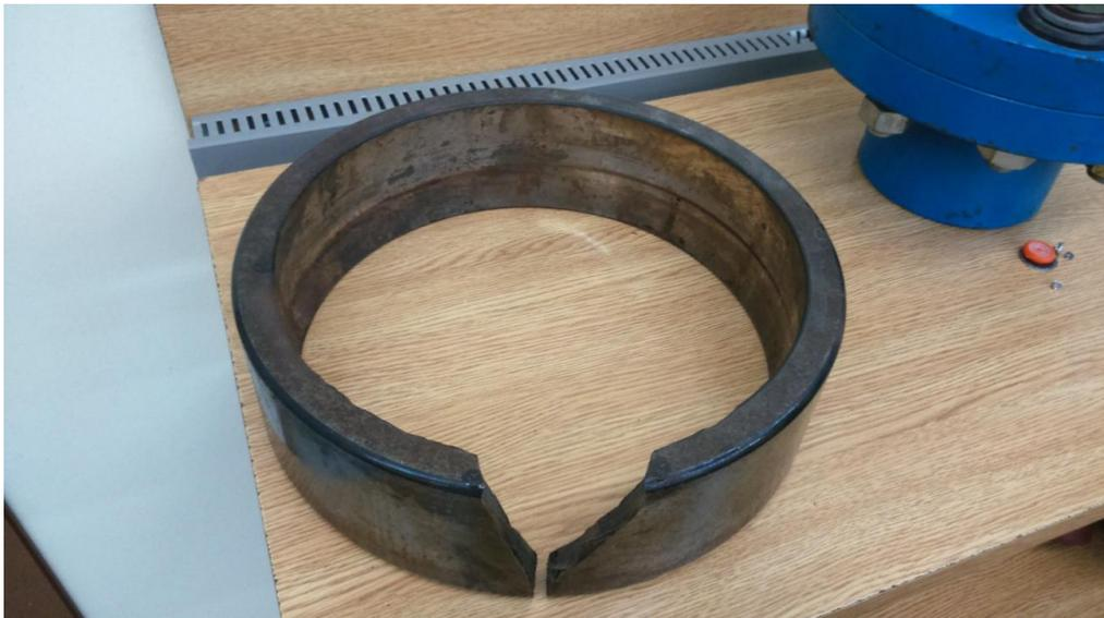
Como se puede observar con claridad se produjo una fractura total del aro en dos zonas próximas, se puede observar una fractura limpia sin existencia de deformación, lo que nos lleva a pensar que se ha producido una fractura por fatiga.
