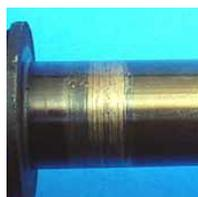
**LUDIMIENTO:** Consiste en la acumulación de depósitos en la superficie de apoyo de engranajes, poleas, rodamientos, cuñas, etc., producto de desgaste y/o oxidación asociados a desplazamientos oscilantes pequeños de estos elementos sobre el eje.
