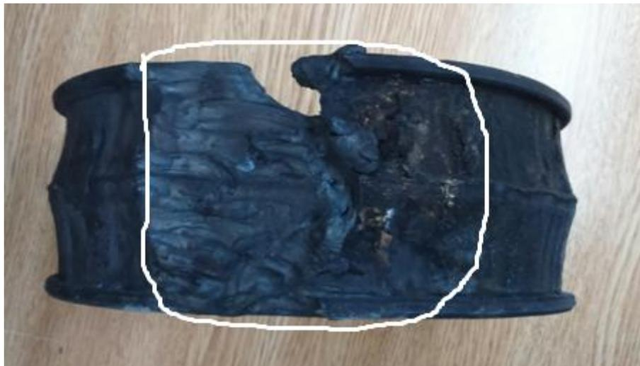
En el aro interior podemos observar una deformación del mismo, este hecho ha sido como consecuencia de una lubricación deficitaria que ha originado el gripaje del rodamiento y la fusión del material como consecuencia de la elevación de temperatura debida al rozamiento de los elementos rodantes en el aro interior.
