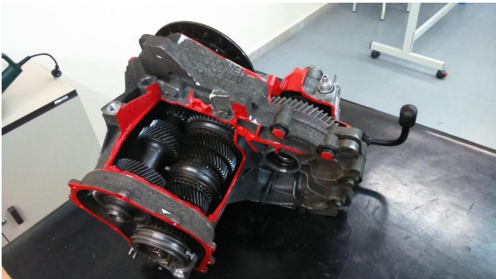
Podemos observar un conjunto de engranajes formada por 2 ejes, 4 marchas y 8 engranajes de distinto tamaño y tipos (normales y Helicoidales).
