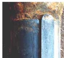
POR PICADURA: Se presenta ataque corrosivo localizado en puntos de la superficie del eje, generando cavidades y dejando residuos.
