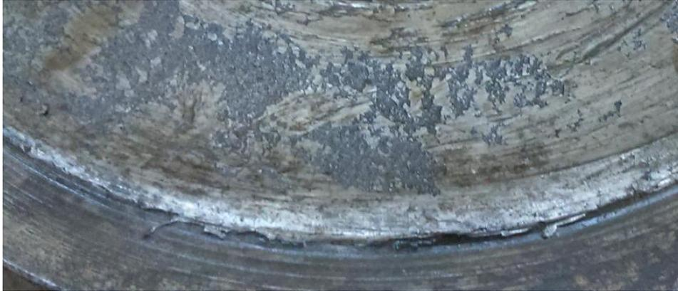
En la **zona "B"** es la sección en la que desaparecen las líneas de crecimiento, desarrollándose desgarro dúctil, debido a una rotura por fractura.
