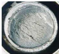
FRÁGIL POR TORSIÓN: Fractura a 45° alrededor del eje con apariencia granular y sin deformación del elemento.
