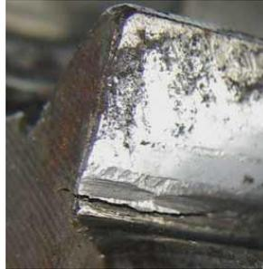
GRIETAS EN ALMA O LLANTA: Grietas originadas en pie de diente que buscan el centro del engranaje. Normalmente formadas por fatiga.
