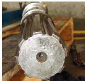
PANDEO DE LÁMINA POR FLEXIÓN: Se da en ejes huecos de pared delgada donde por flexión se dobla la pared.
