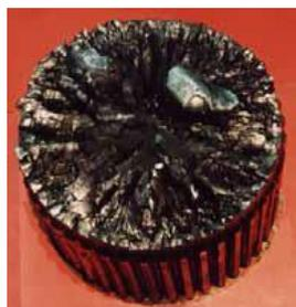
**FATIGA POR FLEXIÓN:** Agrietamiento en servicio transversal al eje. Superficie de fractura tersa sin deformación del eje, normalmente con marcas elípticas concéntricas al origen.
