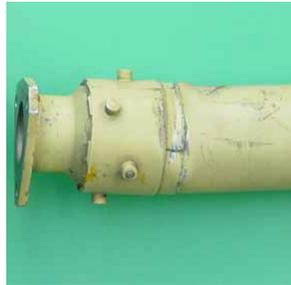
FLUJO PLÁSTICO POR TORSIÓN: El eje muestra deformación permanente por torsión.
