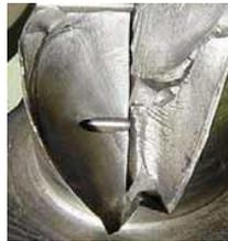
**FATIGA POR TORSIÓN EN EJE ESTRIADO:** Se forman múltiples grietas de fatiga por torsión a 45° alrededor del eje, que surgen a partir de la base de las estrías, las cuales al crecer se encuentran y generan una superficie de fractura irregular.
