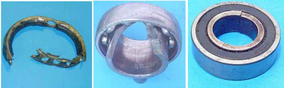
**LUDIMIENTO:** Se presentan depósitos oscuros en las superficies de apoyo con el eje o su alojamiento, indicando que en servicio se dieron pequeños movimientos oscilantes entre las partes (desgaste y/o oxidación).
