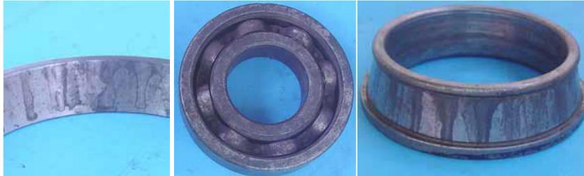
**DESCARGA ELÉCTRICA:** Debido al paso de corriente eléctrica AC o DC a través del rodamiento se generan arcos eléctricos entre los elementos rodantes, las pistas y las jaulas, que erosionan las superficies debido a la fusión a pequeña escala. Producto de los arcos se pueden generar patrones de estrías o cráteres profundos si la corriente es alta.
