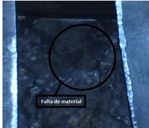
Estos defectos son una consecuencia de dos hechos, el primero es del mal montaje el cual ha producido la deformación y rotura de la jaula la cual a la vez a producido deslizamiento de lo elementos rodantes por la cara del aro interior, conllevando la realización de roces y choques de los elementos con la misma.
