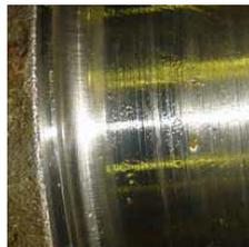
**ADHESIVO:** Cuando entre el eje y su cojinete o seguidor se transfiere metal, debido a que entran en contacto directo porque se rompe la capa de lubricante.
