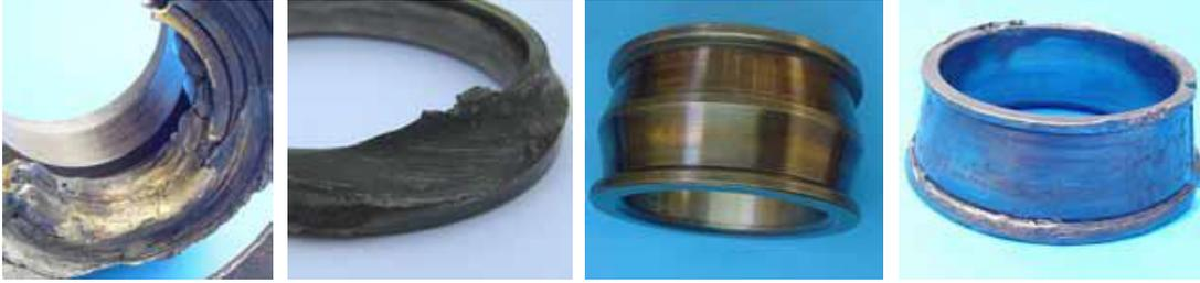
**INDENTACION:** Se trata de creación de cráteres o hendiduras sobre las superficies de rodadura, producto de la deformación plástica derivada de fuerzas de contacto excesivas entre los elementos del rodamiento y/o por presencia de partículas contaminantes entre ellos.
