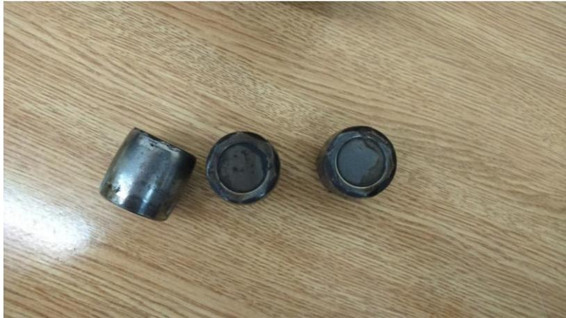
Este hecho es debido por una rodadura irregular y debido al rozamiento de los mismos con el aro interior del rodamiento, la causa de este hecho es de la deformación del aro interior por las causas que antes se han comentado que conllevó al rozamiento de los elementos rodantes con el propio aro deformado, produciendo una rodadura irregular la que produjo el desgaste de los elementos rodantes.
