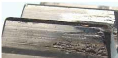
**INTERFERENCIA:** En la base de los dientes se nota un desgaste anormal generado durante la operación.
