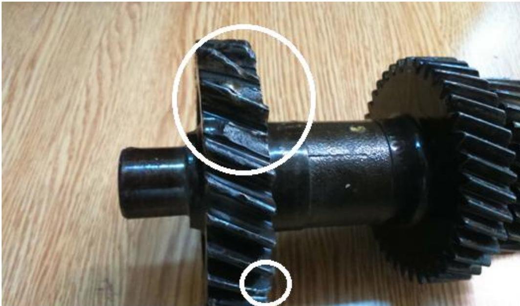
Es un fallo por fatiga metalúrgica que se manifiesta con el desprendimiento de pedazos de metal relativamente grandes de las superficies de los dientes. La superficie metálica de un diente de engrane tiende a deformarse elásticamente bajo la carga transmitida y a formar ondulaciones que se desplazan adelante y atrás de la línea de contacto.
