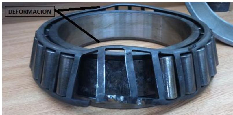
Las causas más probables de este defecto es un mal montaje, más concretamente un desalineamiento del rodamiento, produciendo roces o choques del propio rodamiento con otros elementos que a la postre produciría la deformación y rotura de la propia jaula.
