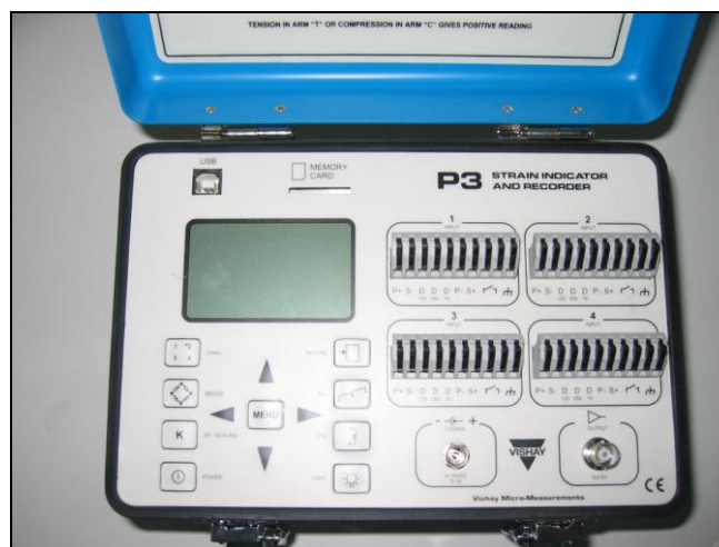
Fig 50. Aparato de extensometría modelo P3 de Vishay Measurement Group.
