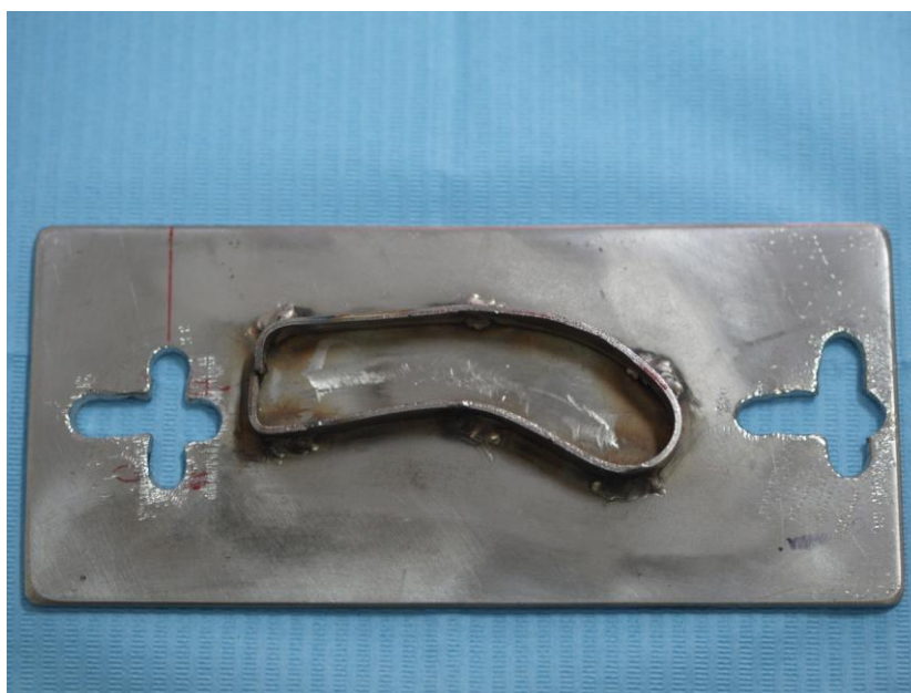
Fig. 53. Pieza metálica para fijar el modelo a la máquina de ensayos.
