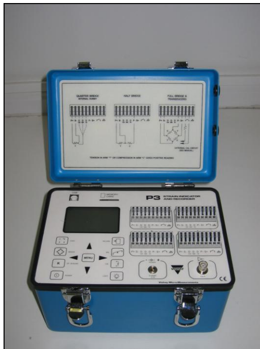
Fig. 49. Aparato de extensometría modelo P3 de Vishay Measurement Group.
