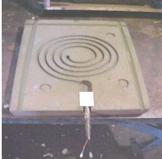
Figura 14. Parte inferior del molde con termopar
