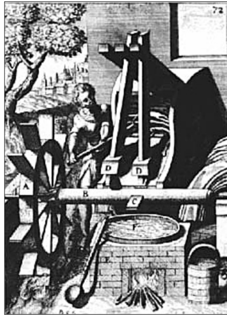
Figura 2. Un batán del siglo XVII (Böckler, 1997) A: rueda vertical, B: árbol de levas, C: leva, D: martillos
