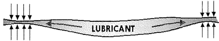
Figura 3.14 Huella actuando como depósito de lubricante [30].
