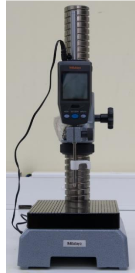
Figura 4.18. a) Equipo de electropulido Polimat 2 Buehler, b) micrómetro vertical Mitutoyo ID-H0560.
