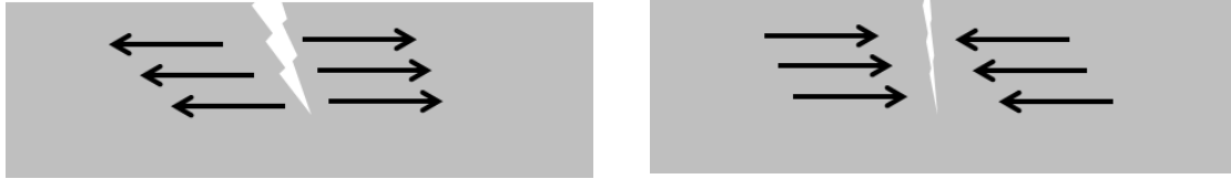
Figura 3.2. Efecto de las tensiones residuales de tracción (a) y compresión (b) en un defecto superficial.
