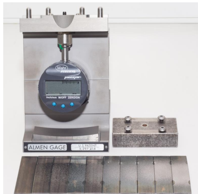
Figura 4.6. Medidor Almen, bloque Almen y placas Almen tipo A sometidas a distintos tiempos de tratamiento.
