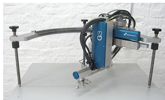
Figura 4.12. a) Unidad principal X3003, b) goniómetro G3R.
