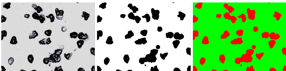
Figura 4.7. Fotografías del acero T+R540 tras un tratamiento de 3 segundos de 16A. a) Fotografía original, b) fotografía retocada, c) fotografía analizada.
