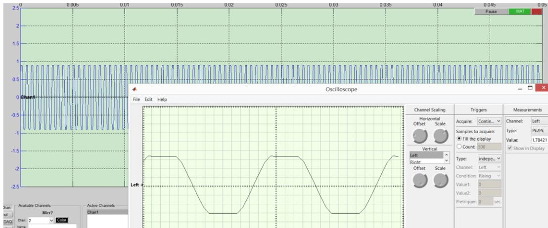
Para evitar este recorte reducimos la tensión de la señal generada, quedando: 2KHz Sinusoidal y 0,6 Vpp.
