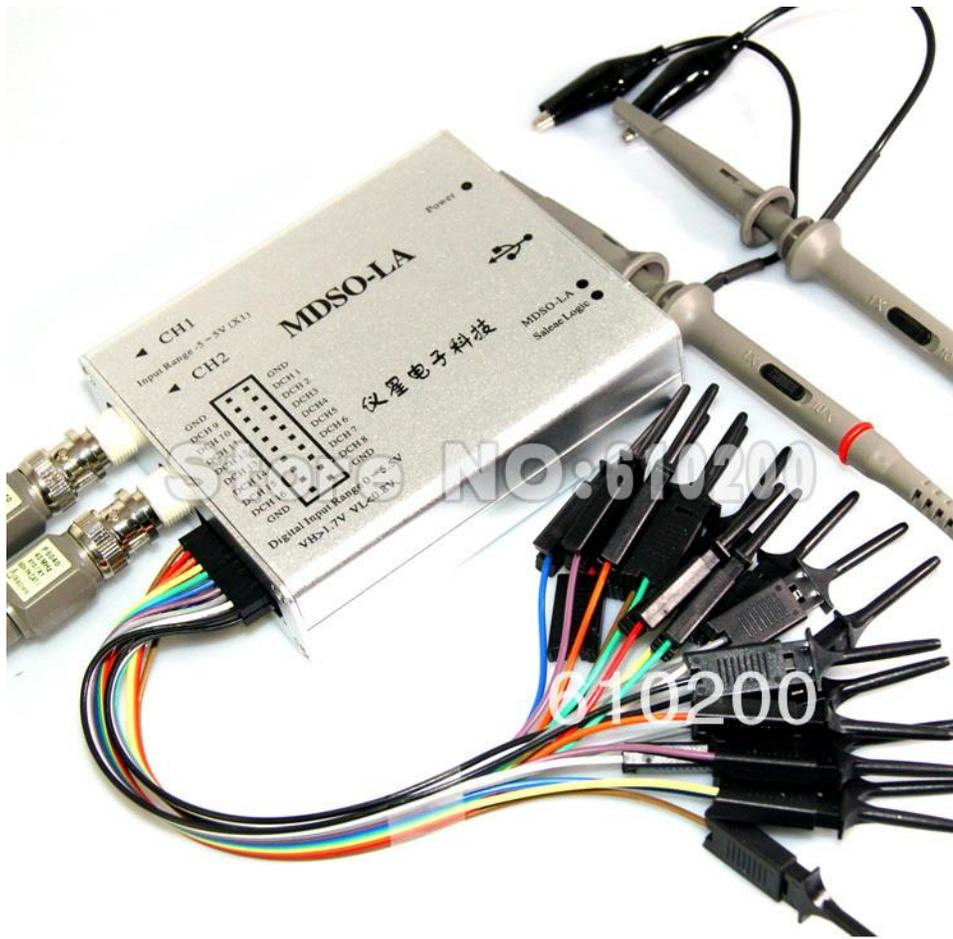
*Fig. 7 - Conversor A/D externo crear un Osciloscopio mediante PC*
