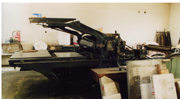
Figura 8: Prensa litográfica J. Voirin, Litografía Viña. (Fotografía tomada por Francisco Velasco en 1997).
