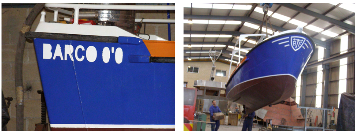
Figura 7.8.- Vista de la pintura de la obra viva y de la obra muerta de la embarcación.
