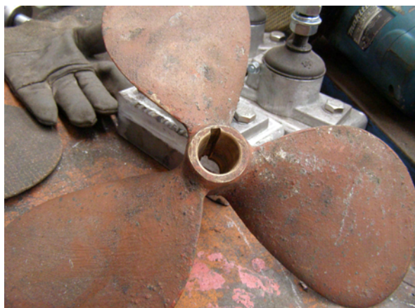
Figura 7.18.- Hélice de tres palas, antes de su tratamiento superficial en el astillero.
