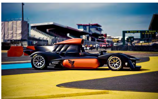
Figura 4.13. "Green GT H2" Vehículo de competición propulsado por una pila de combustible de hidrógeno.
