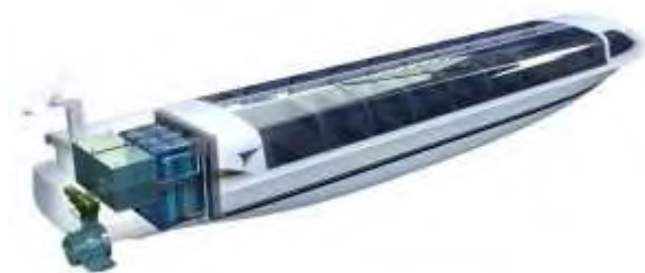
Figura 4.24.- "Nemo H2", con propulsión pila PEM en funcionamiento en los canales de Ámsterdam.
