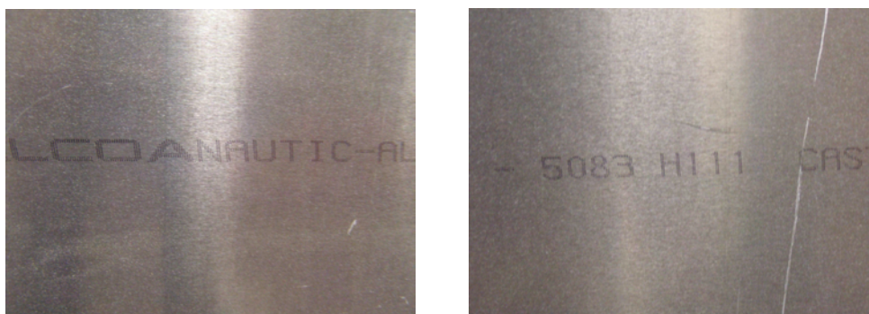
Figura 7.2.- Aluminio naval ALCOA 5083-H111.
