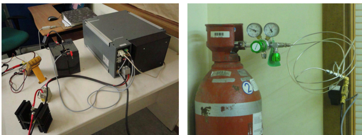
Figura 7.43.- Instalación de la pila PEM NEXA y del sistema de alimentación de hidrógeno en el laboratorio, durante los ensayos realizados.
