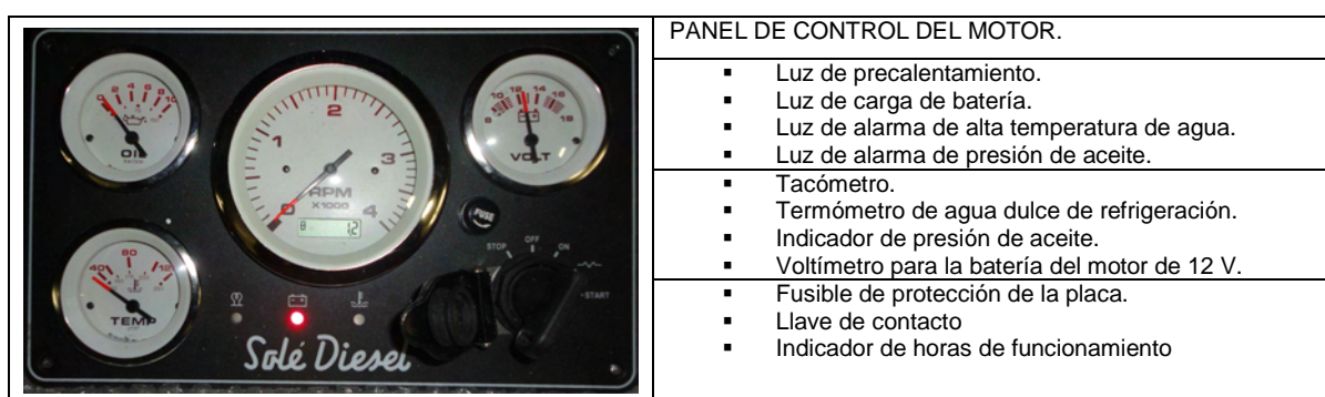
Figura 7.12.- Panel de control del motor Sólé DIESEL MINI-17.
