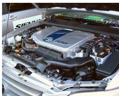
Figura 4.12.- Propulsor del Toyota FCHV PEM FC.
