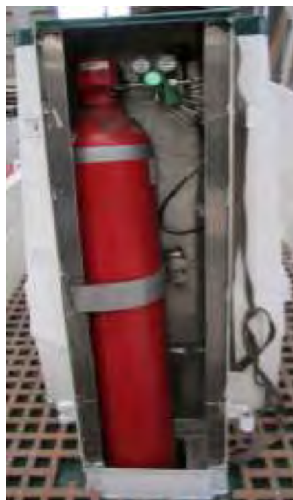
7.49.- Integración de la botella de hidrógeno en la estructura de almacenamiento.
