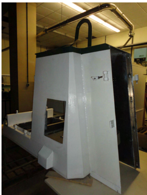
Figura 8.1.- Orificio practicado en el guardacalor para mejorar el acceso a la caja de enlace DC.
