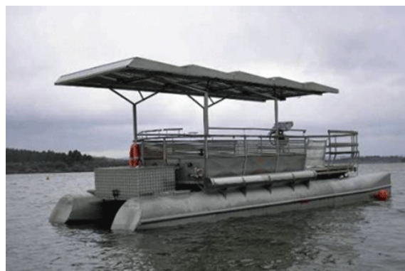
Figura 4.25.- Barco eléctrico con propulsión híbrida en el pantano de la Cuera (Cuenca).
