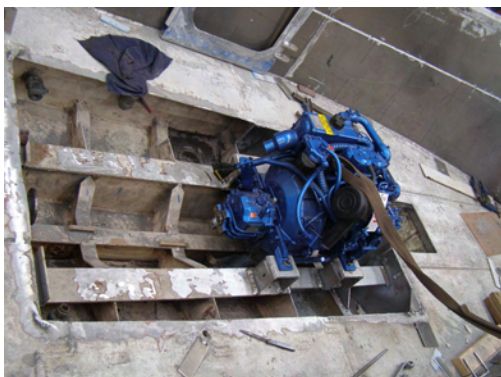
Figura 7.4.- Nuevo asiento del motor diésel y soporte para el anclaje del motor eléctrico.
