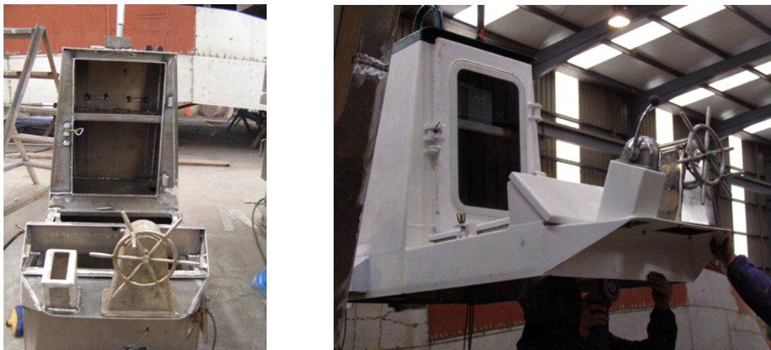
Figura 7.5.- Estructura fabricada sobre el guardacolor de la embarcación.
