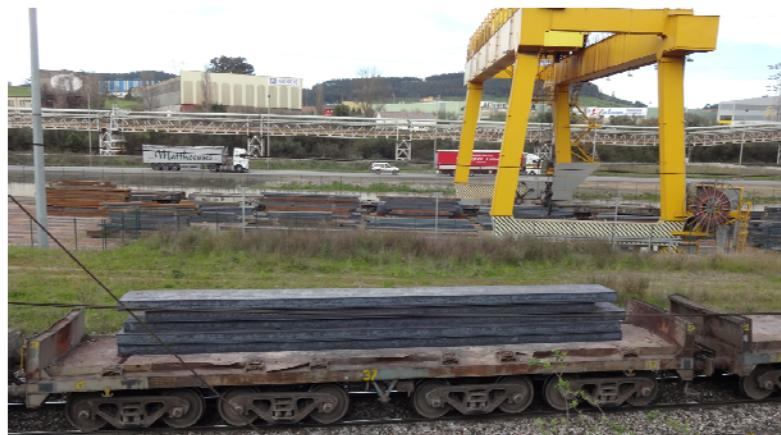
**Figura 2.14.** Parque regulador de slabs, con un tren transportando slabs de la acería
