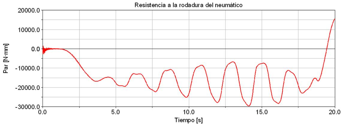
Figura 4.127. Gráfico de la resistencia a la rodadura en el neumático delantero derecho en el sistema real.
