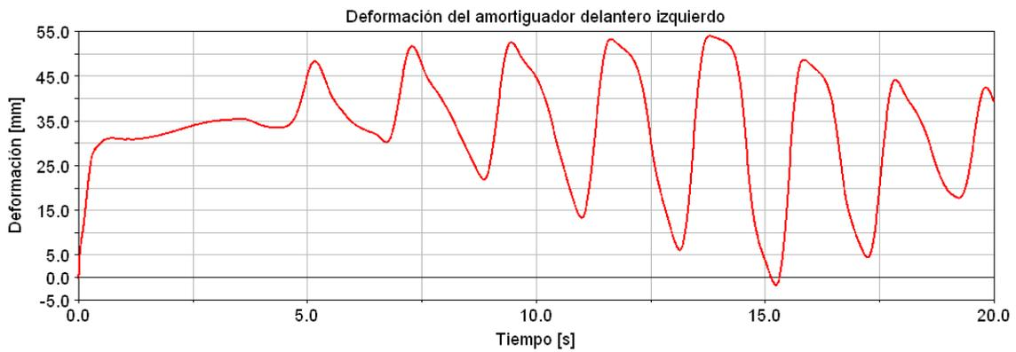
Figura 4.58. Gráfico de la deformación del amortiguador delantero izquierdo en el sistema real.
