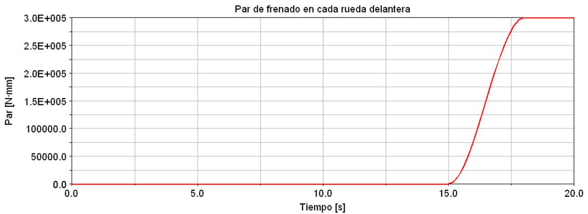
Figura 8.17. Par de frenado en cada rueda delantera para la realización de la maniobra con el modelo completo de vehículo.
