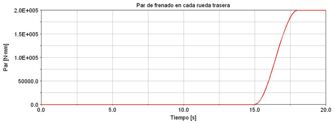
Figura 8.18. Par de frenado en cada rueda trasera para la realización de la maniobra con el modelo completo de vehículo.
