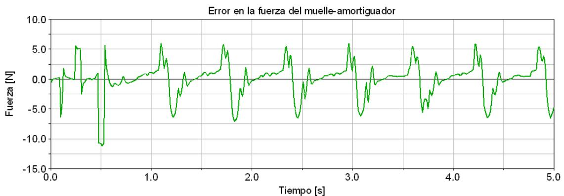
Figura 3.28. Gráfico del error de la fuerza del muelle-amortiguador en la estimación de estados respecto del sistema real.
