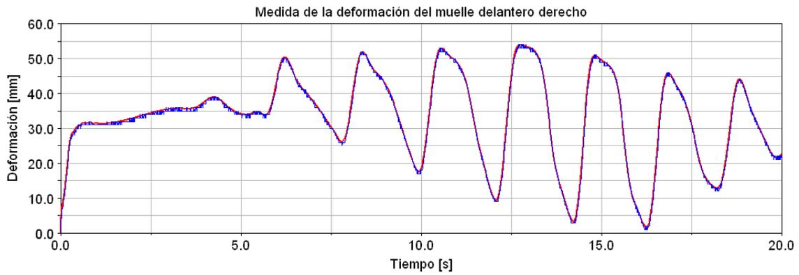
Figura 4.85. Gráfico de la deformación del muelle delantero derecho en el sistema real (rojo) y el resultado de la medida al añadir un ruido aleatorio (azul).
