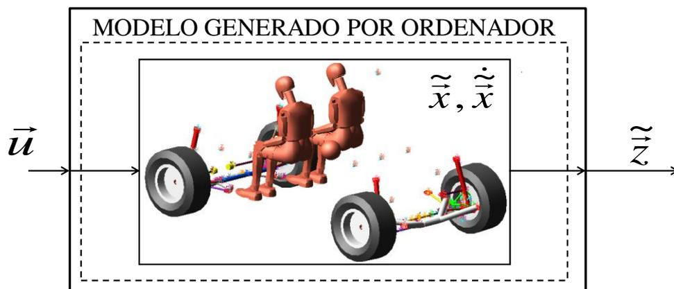
Figura 3.5. Diagrama de la simulación del modelo CAE de un sistema dinámico, particularmente de un vehículo.
