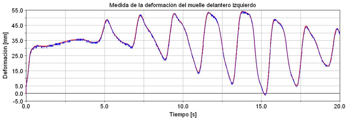
Figura 4.86. Gráfico de la deformación del muelle delantero izquierdo en el sistema real (rojo) y el resultado de la medida al añadir un ruido aleatorio (azul).
