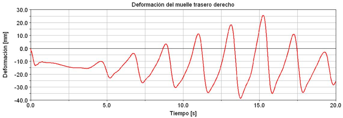
Figura 4.49. Gráfico de la deformación del muelle trasero derecho en el sistema real.
