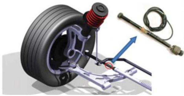
Figura 4.181. Instrumentación de la bieleta de dirección por extensometría para la medición de la fuerza normal (Luque, 2013).
