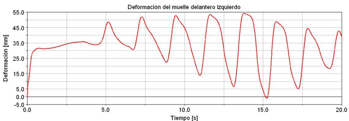
Figura 4.48. Gráfico de la deformación del muelle delantero izquierdo en el sistema real.
