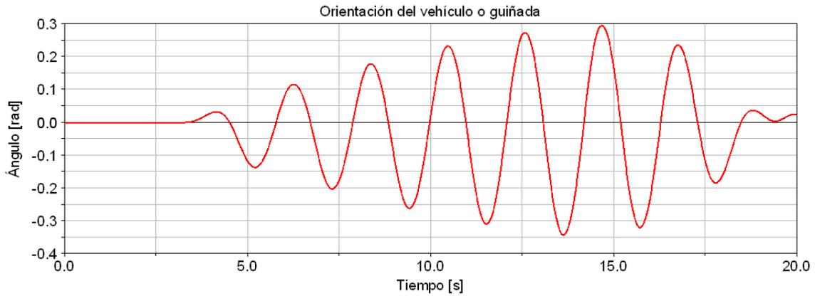
Figura 4.121. Gráfico de la guiñada del vehículo en el sistema real.
