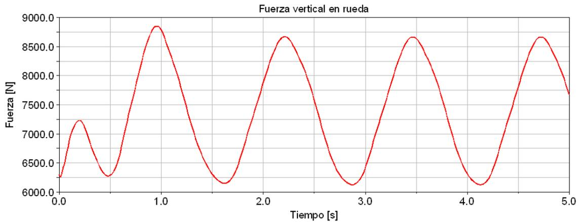
Figura 4.12. Gráfico de la fuerza vertical en la rueda en el sistema real.
