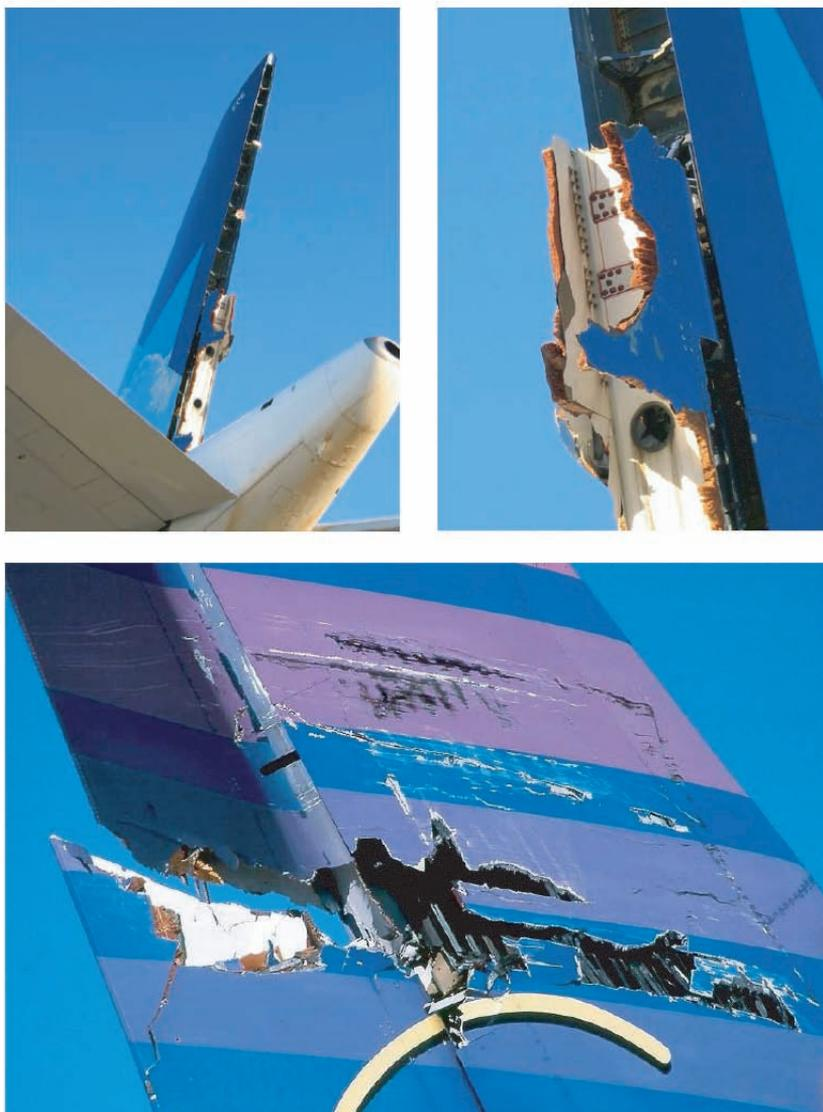
Figura 1.9: Ejemplos de deslaminación en aeronave A310 (Airbus).
