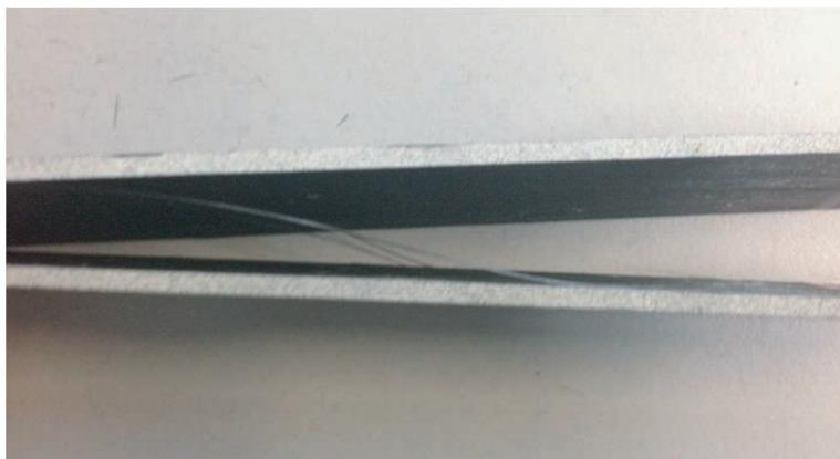
Figura 5.7: Puentes de fibra durante un ensayo para el material AS4/3501-6.
