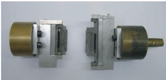
Figura 4.6: Montaje de agarres mecánicos empleados en el presente trabajo.
