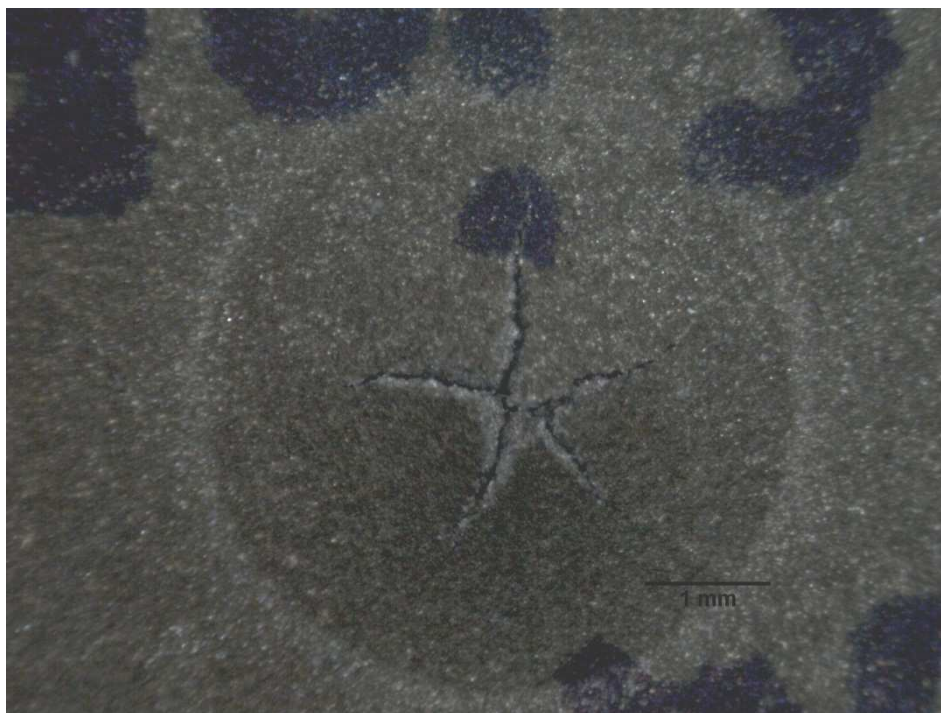
Fig. 5.4 Aspecto de la rotura presentada por una probeta SPT del material AES
