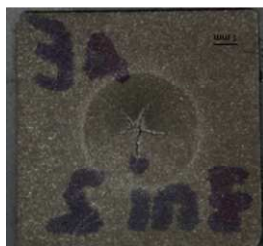
a) Aspecto de una probeta de ensayo SPT en un material frágil
