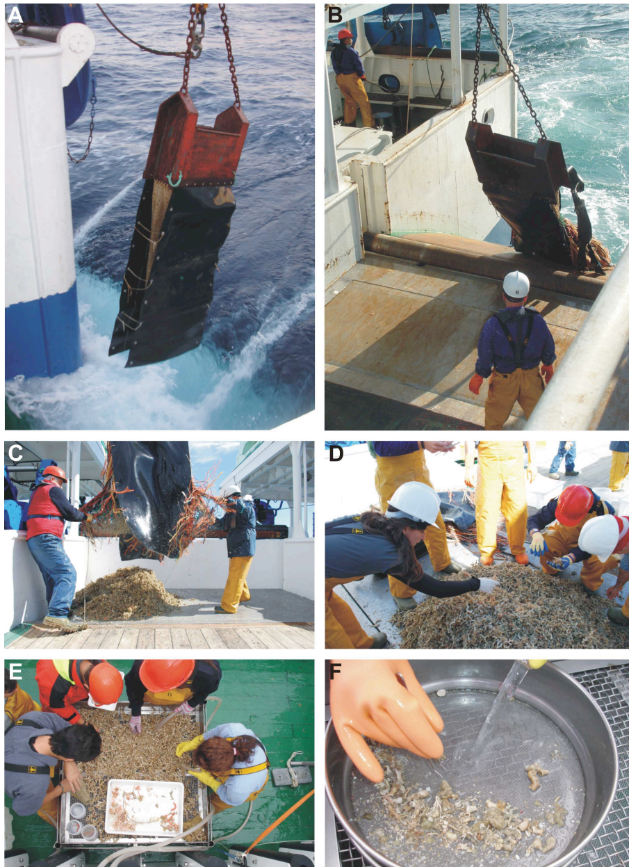
Figura 5.3. Draga de roca utilizada para los muestreos en las campañas Patagonia. Maniobra de muestreo largado y virado de la draga, vertido del material recolectado en la cubierta del barco para su posterior tratamiento.
