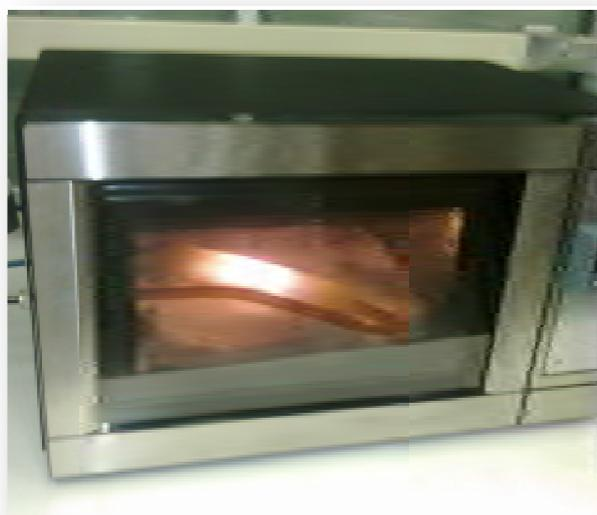
**Figura 3.12.** Horno multimodo microondas
