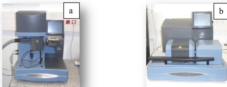
**Figura 3.18.** Termobalanzas empleadas. **a)** TGA-Q5000 y **b)** SDT-Q600
