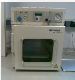
**Figura 3.15.** Estufa de vacío para el secado final de las muestras.
