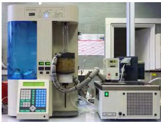
**Figura 3.27.** Equipo Quantachrome Instruments NOVA 4200e
