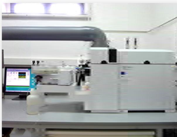
**Figura 3.21.** Equipo 7700x Agilent para el análisis por ICP-MASAS
