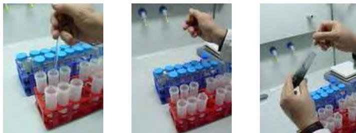
**Figura 3.13.** Adición de HCl 5M para el lavado de la muestra.
