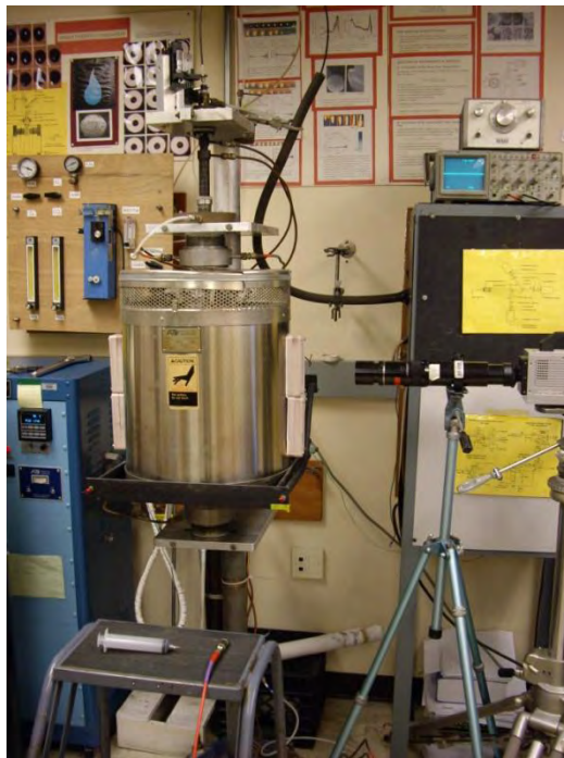
Figura 2.1. Fotografía del dispositivo experimental para el estudio de combustión de partículas en la Northeastern University (Boston, MA).
