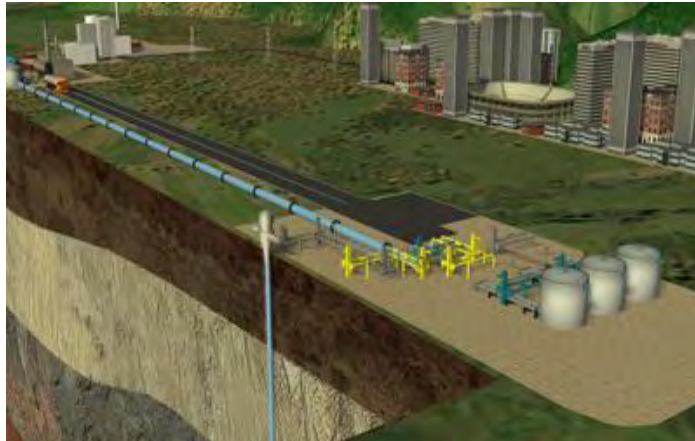
Figura 1.11. Recreación de un pozo de inyección de CO 2 [CIUDEN, 2014]
