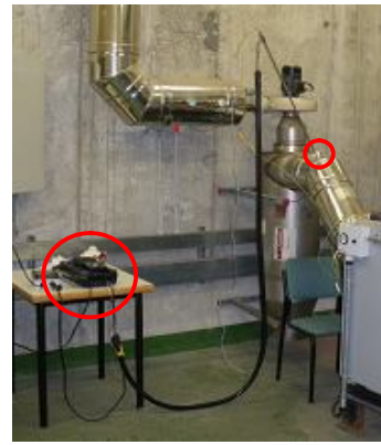
d) Analizador de gases conectado a la chimenea.
