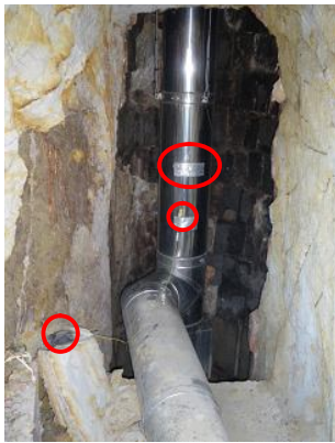
c) Data-logger conectado a la chimenea y punto de muestra para opacidad.
