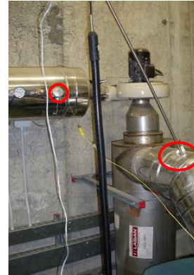
b) Data-logger conectado a la chimenea y toma de muestra para análisis de gases y opacidad.
