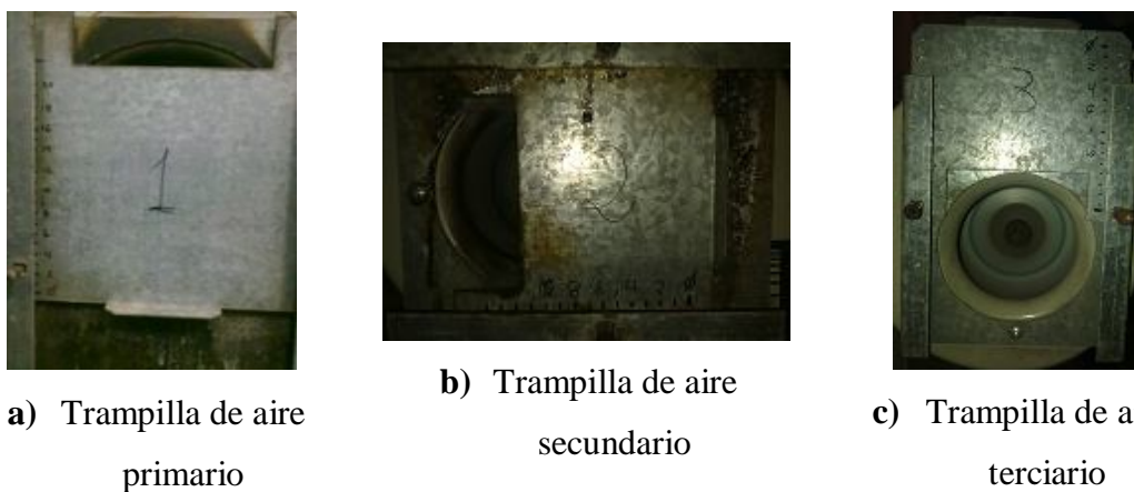
Figura 70. Trampillas de entrada de aire primario, secundario y terciario
