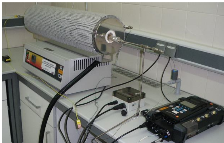
Figura 49. Sistema de medida para el análisis de gases de combustión.
