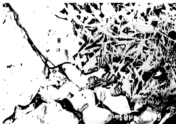
Figura 7. Detalle de la partícula P 57 con estructura óptima de sinterizado (x 750). H = Hematita; F = Red de ferritos. Presencia de ganga (gris oscuro) y porosidad (negro).
