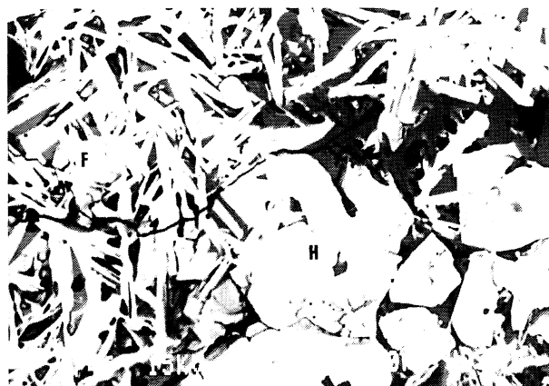
Figura 6. Detalle de la partícula P 54, localizada en la figura 4, con estructura óptima de sinterizado (x 900). H = Hematita; F = Red de ferritos. Presencia de ganga (gris oscuro) y poros (negro).
