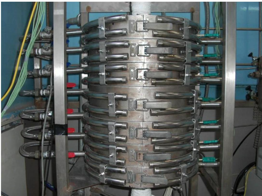
**Figura 3.10: Horno de siete secciones que rodea al reactor.**
