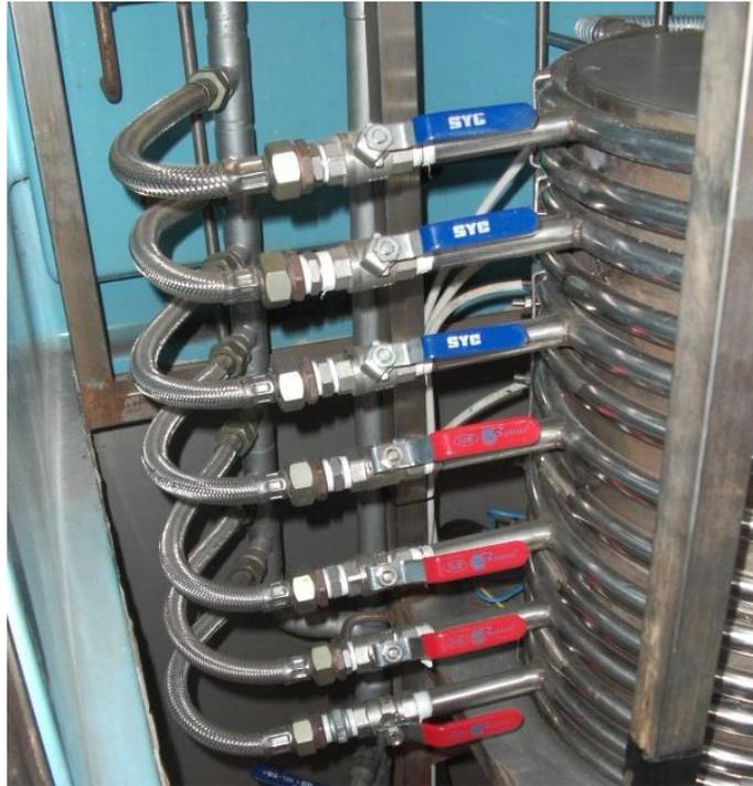
**Figura 3.9: Vista de los conductos de alimentación de aire frío a cada una de las secciones.**
