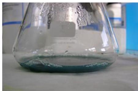
Figura 19. Adición de solución alcalina
