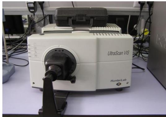
Figura 29. Espectrofotómetro UltraScan VIS (HunterLab).
