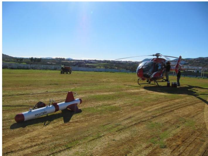
**Fig. 3.3.10. Helicóptero con el que se realizó la magnetometría aeroportada.**
