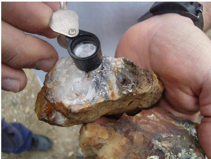
**Fig. 3.3.9. Ejemplo de muestra de seleccionada para análisis químico con una paragénesis de arsenopirita-cuarzo lechoso.**
