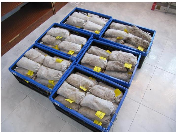
**Fig. 3.3.21. Muestras procedentes de la campaña de geoquímica de arroyos, georeferenciadas, etiquetadas y preparadas para enviar al laboratorio para su análisis multielemental.**
