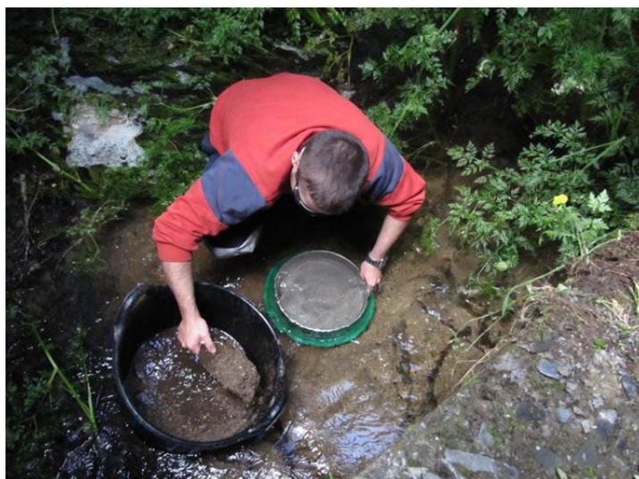
**Fig. 3.3.20. Recogida de muestras de geoquímica de arroyos: tamizado de los sedimentos del arroyo.**
