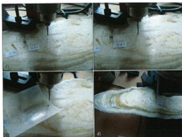
Figura 9. Proceso seguido para la recogida del polvo de estalagmita 10
