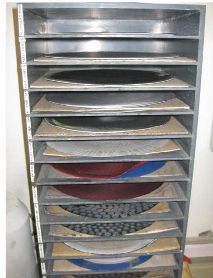
**Ilustración 4.15** Papeles esmerilado mecánico utilizados
