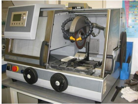
**Ilustración 4.11 Máquina de corte metalográfico**
