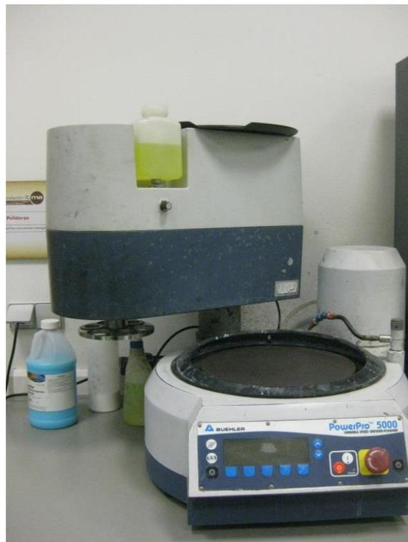
**Ilustración 4.14** Máquina esmerilado y pulido.
