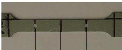
Ilustración 4.7 Marcas para ensayo tracción uniaxial
