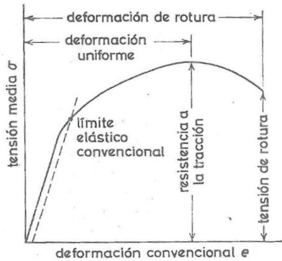
Ilustración 4.8 Curva tensión-deformación
