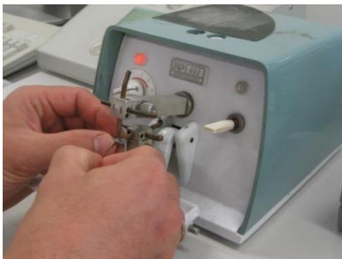
Ilustración 4.3 Máquina para soldar termopar
