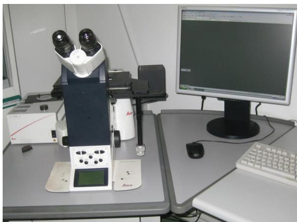
Ilustración 4.16 Equipo observación metalográfica utilizado
