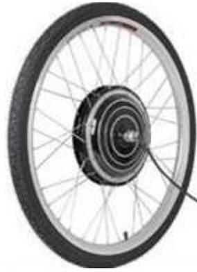
**Figura 91: Rueda trasera con hub-motor**
