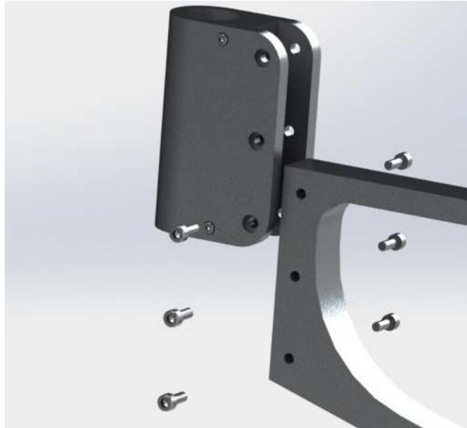
**Figura 83: Montaje sujeción horquilla - bastidor**
