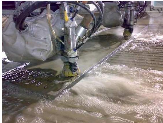
**Figura 72: Balsa de agua corte por chorro de agua**
