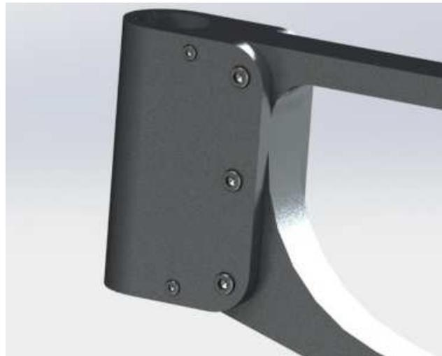
**Figura 84: Resultado montaje sujeción horquilla - bastidor**
