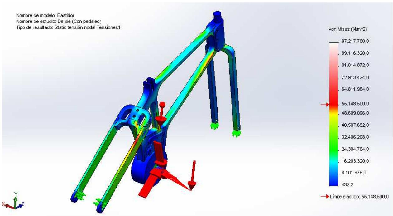
**Figura 61: Ensayo de pie con pedaleo, Tensión máxima: 97,22x10<sup>6</sup> N/m<sup>2</sup>**
