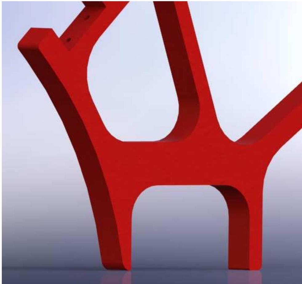
**Figura 31: Zona de asiento para el generador eléctrico**
