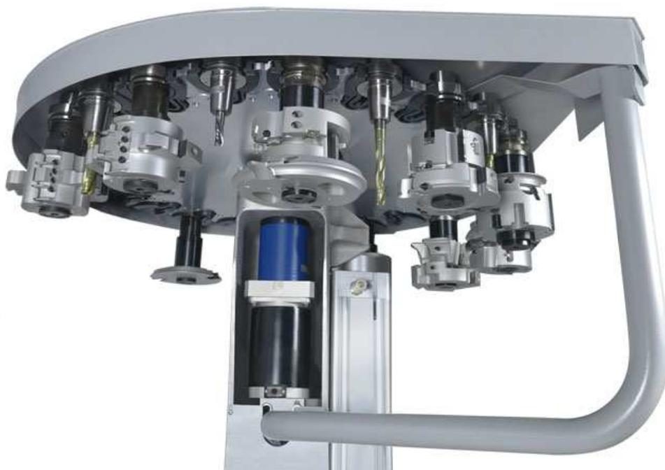
**Figura 79: Mecanismo cambio de herramienta**
