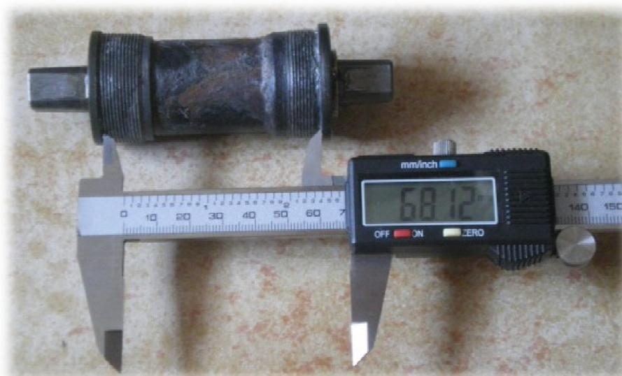
Figura 8: Medición del ancho del eje pedaliar
