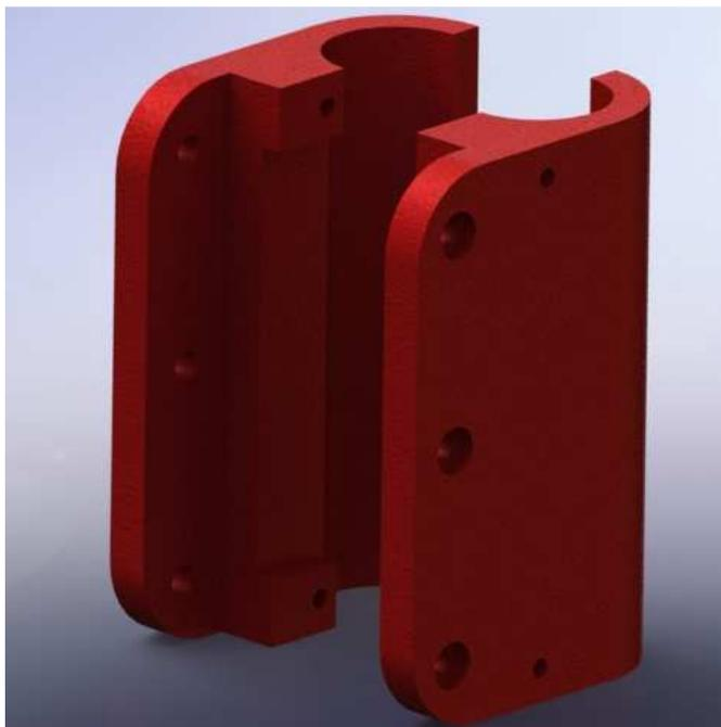
**Figura 32: Sujeción de la horquilla definitivo**
