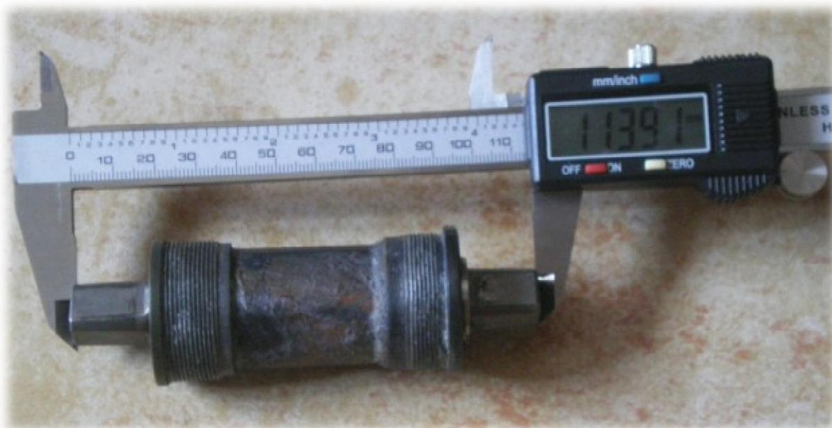
**Figura 6: Medición longitud eje de pedalier**
