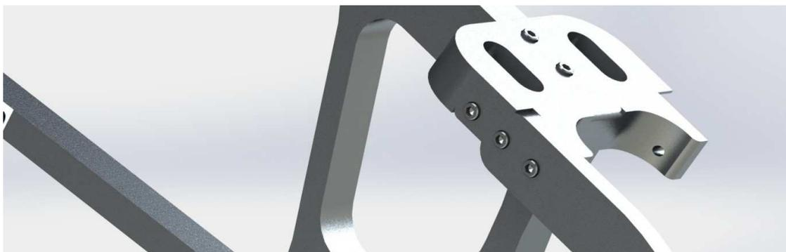
**Figura 88: Resultado montaje brazo trasero - unión trasera**
