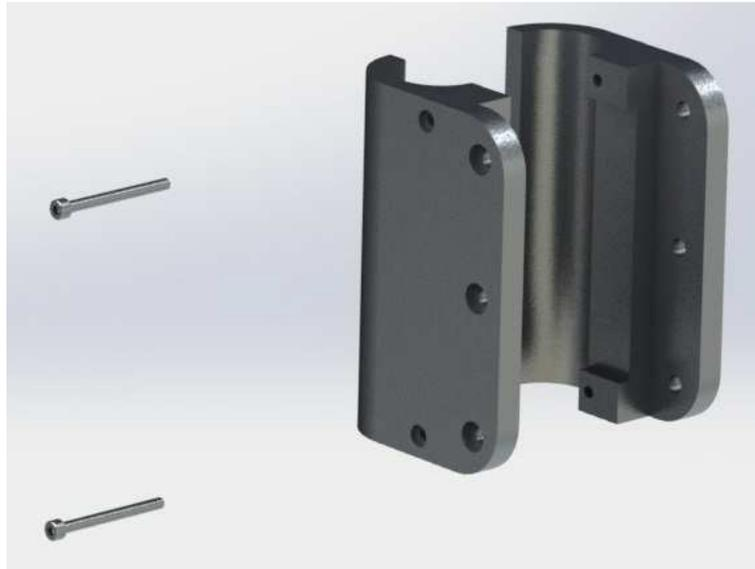
**Figura 81: Montaje sujeción horquilla**
