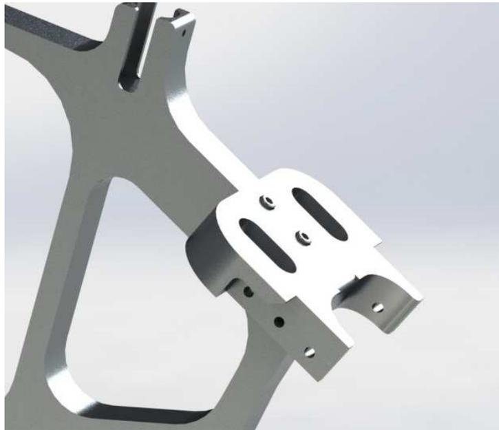
**Figura 86: Resultado montaje unión trasera - bastidor**
