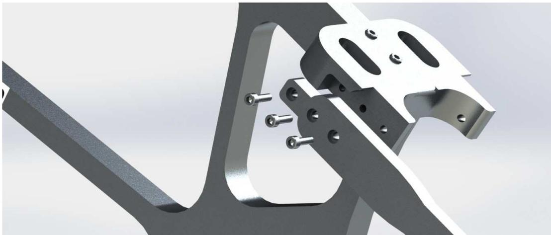
**Figura 87: Montaje brazo trasero - unión trasera**
