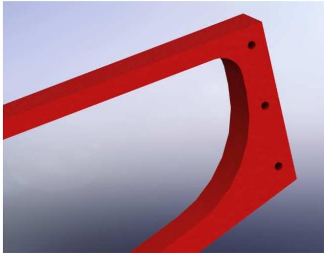
**Figura 28: Roscados para tija de bastidor definitivo**
