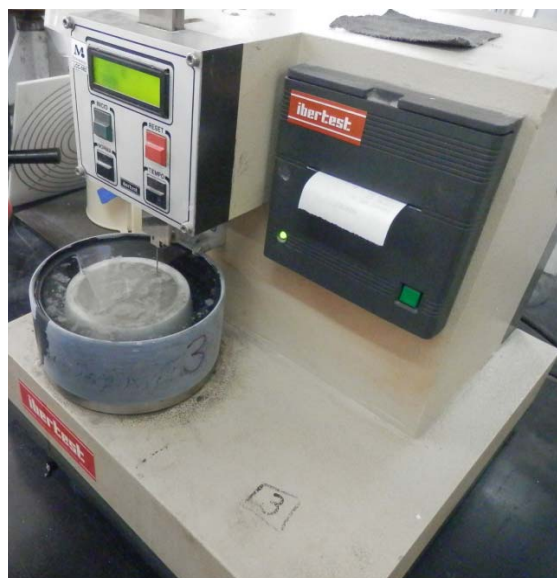
Figura 2.5. Aparato de Vicat automático realizando un ensayo de tiempo inicial de fraguado.
