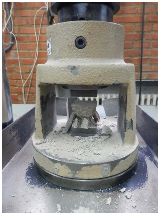
Figura 2.6. Probeta de cemento ensayada a compresión.
