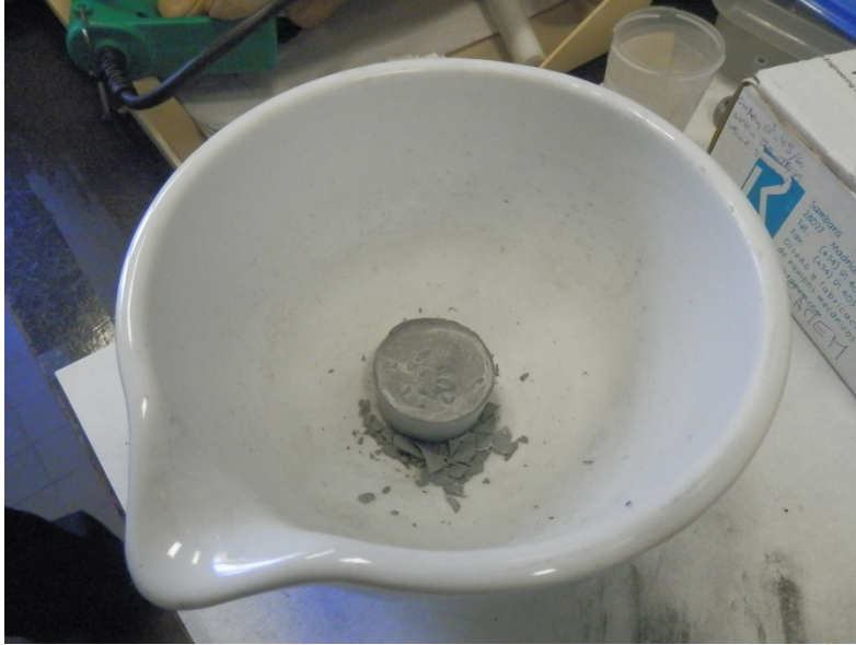
Figura 2.1. Mortero con muestra fraguada de cemento con 5 % de zeolita, dispuesta para su triturado.
