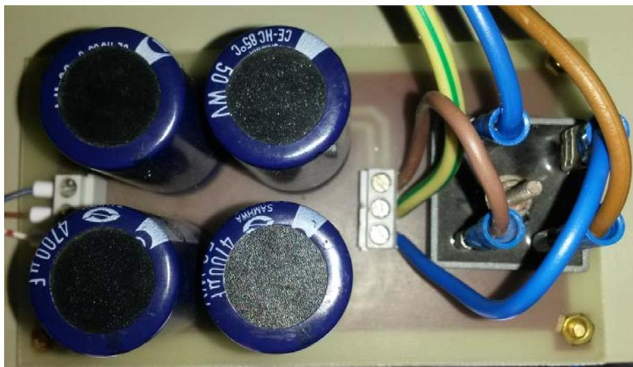
**Figura 3.16** Placa de fuente de voltaje  $\pm 24V$
