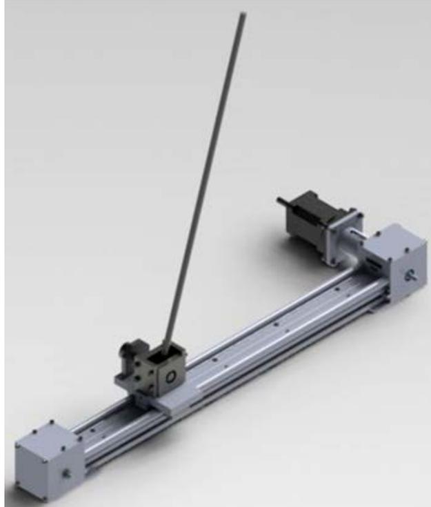
**Figura 4.15** Nuevo prototipo de péndulo invertido
