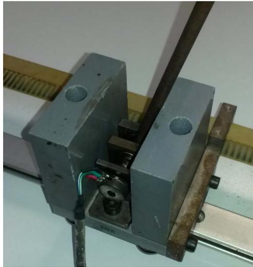
**Figura 4.1** Carro con péndulo invertido
