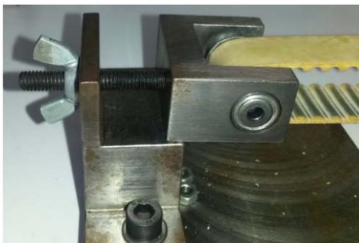
**Figura 4.2** Ajuste de tensión de correa
