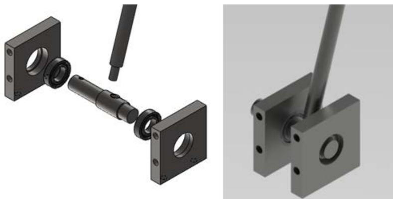
**Figura 4.21** Montaje del árbol central del carro
