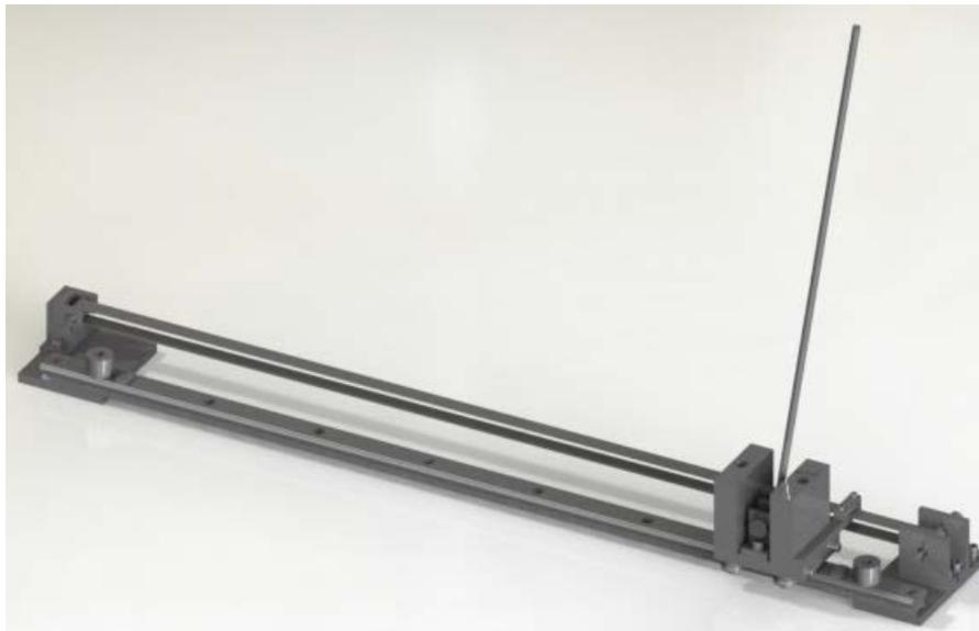
**Figura 1.2** Planta péndulo invertido
