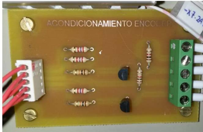
**Figura 3.15** Placa de acondicionamiento de señales de encoder
