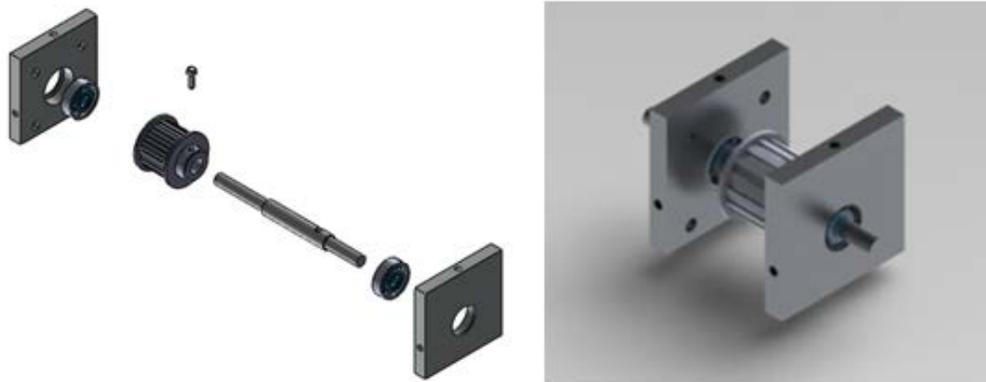
**Figura 4.16** Montaje de la polea conductora en soportes
