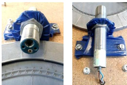
**Figura 3.9.** Sensor interruptor fotoeléctrico SQUARE-D Class 9007.
