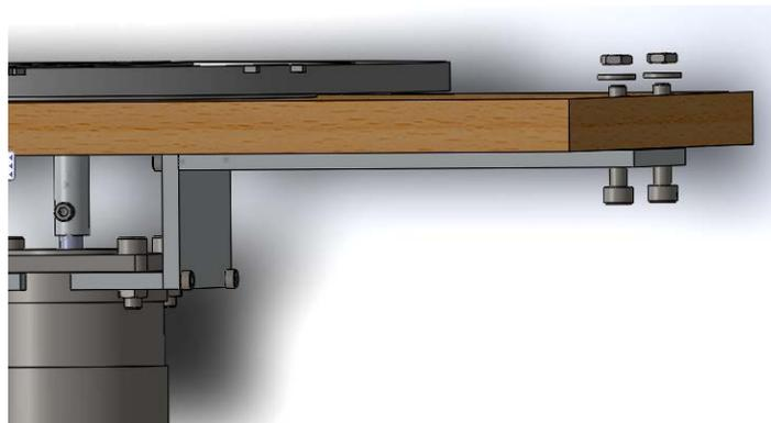
**Figura 3.37.** Ajuste de mecanismo de soporte al tablero.
