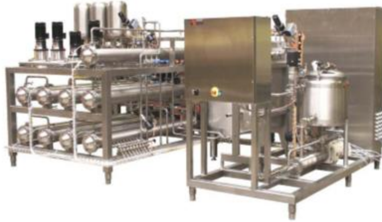
Figura 21. Equipo APV LeanCreme [31].
