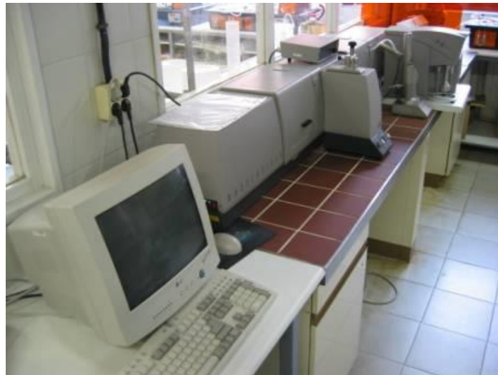
Figura 38. Equipo Malvern Mastersizer S Long Bench .
